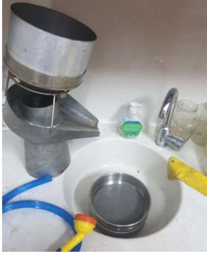
Şekil 5. Nematod kistlerinin örneklerden Fenwick kabı ile elde edilme işlemi.
