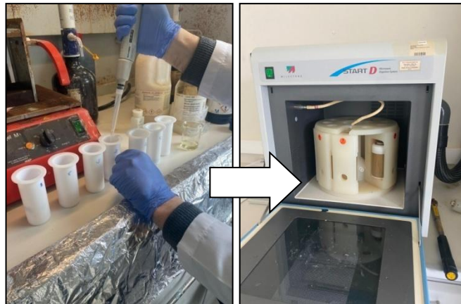
Şekil 18. Numunelere asit eklenmesi ve yakılmak üzere fırına yerleştirilmesi
