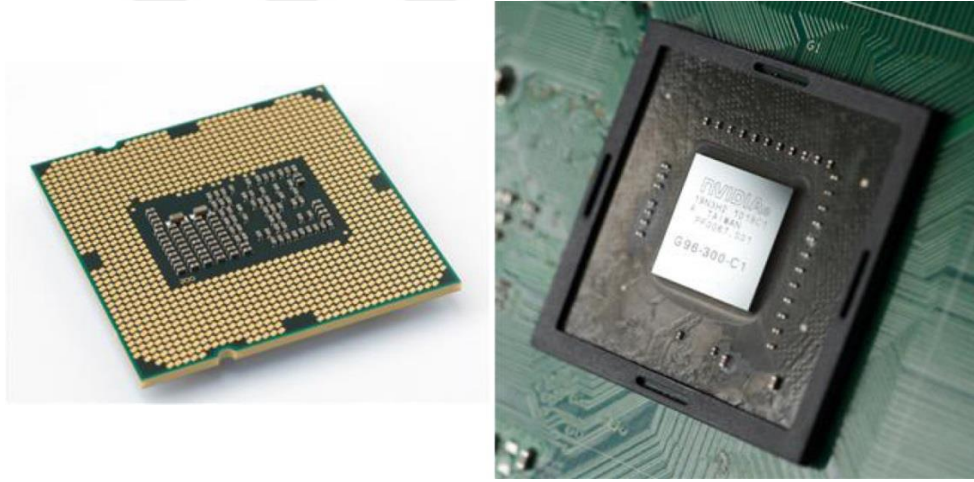
Şekil 1.8. Sırasıyla Mikroişlemci (CPU) Ve Grafik İşlemcisi (GPU)
