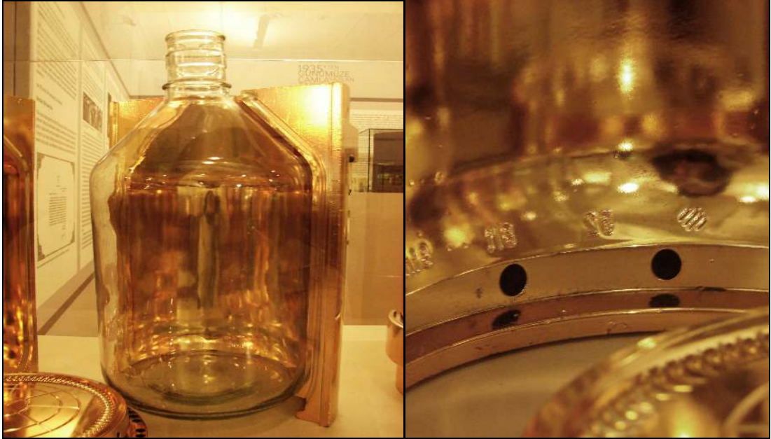
Şekil 3: IS Makinelerinde üretilen en büyük hacimli şişe ve üretimde kullanılan kalıp (Kaynak: 'Kum Ateş ve Cam: Şişecam...' 1935'ten Günümüze Camla Yazılan Tarih, İstanbul Sergisi'nden fotoğraflanmıştır, 01 Şubat 2012.)
