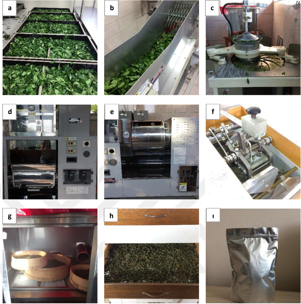
Şekil 3.1. Çayların üretimi işlem aşamaları ve muhafazası; a) soldurma; b) buharlı ısıtma işlem; c) ortodoks kıvrırma; d) 1. döner tamburlu kıvrırmalı kurutma; e) 2. döner tamburlu kıvrırmalı kurutma; f) son kıvrırmalı kurutma; g) fermentasyon; h) son kurutma; i) muhafaza
