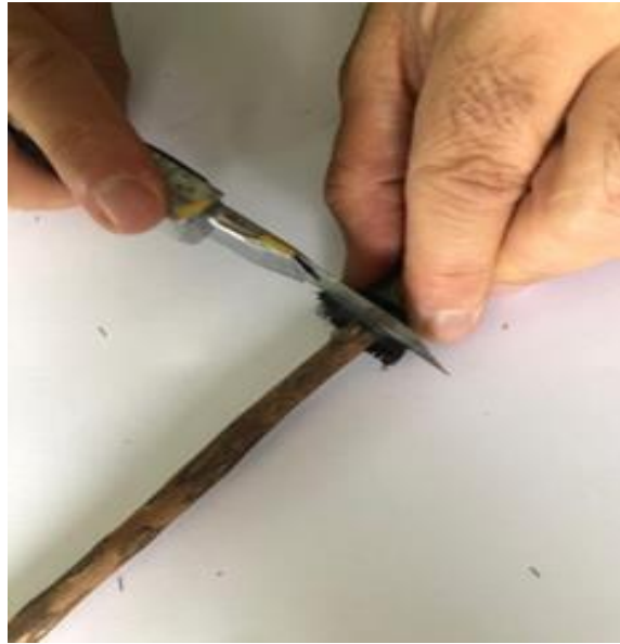
Görsel 38: Fırçanın dip kısmının falçata ile düzeltilmesi, (Can:2022)
