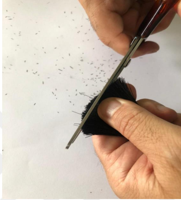
Görsel 37: Fırça uçlarının makas ile düzeltilmesi, (Can:2022)
