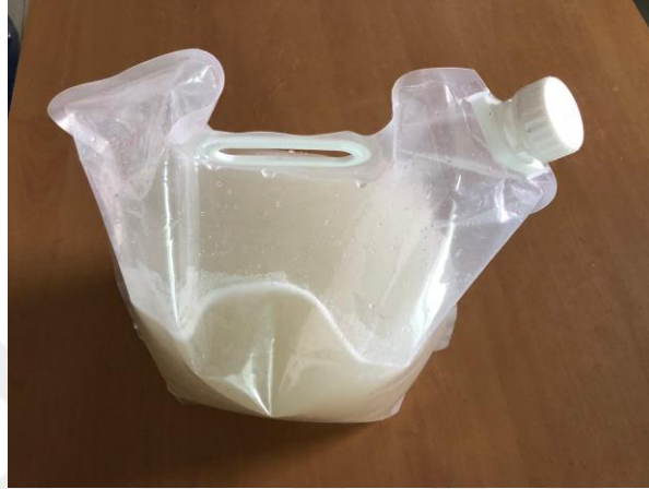
Görsel 63: Kıvam artırıcının, plastik bir kap içinde dinlendirilmesi (Can: 2022)
