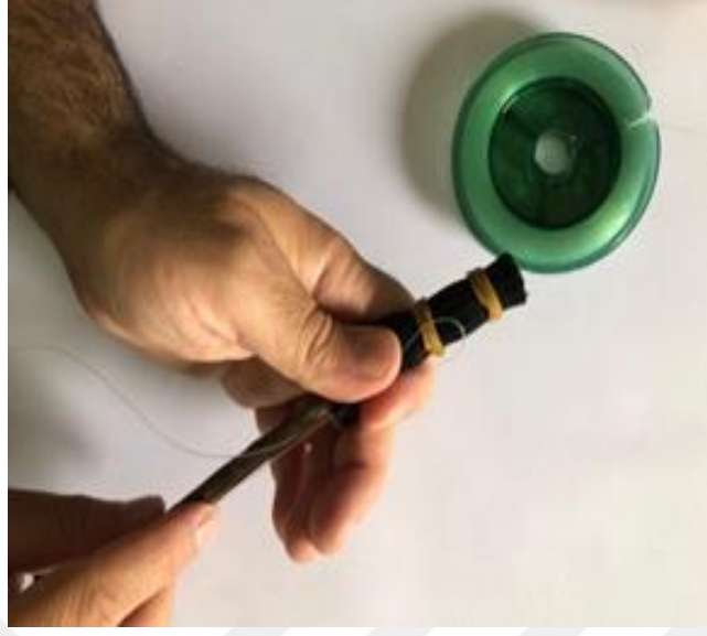
Görsel 33: Misinin ucunun ters U şeklinde, gül dalına paralel bir şekilde tutulması, (Can: 2022)
