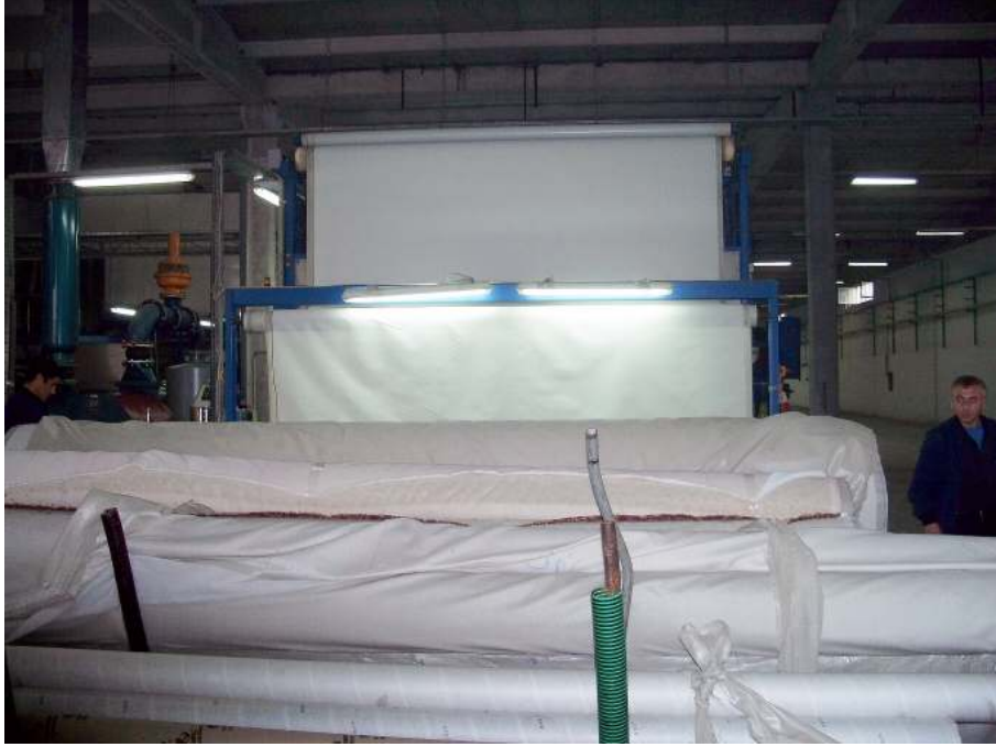
Fotoğraf 109: Büyük Baskı Makinesi Halının İlk Giriş Yeri(Samur Halı Fabrikası Ankara)
