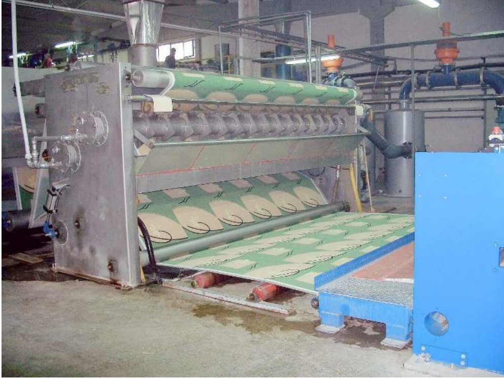
Fotoğraf 115: Büyük Baskı Makinesi Sıkma İşlemi(Samur Halı Fabrikası Ankara)
