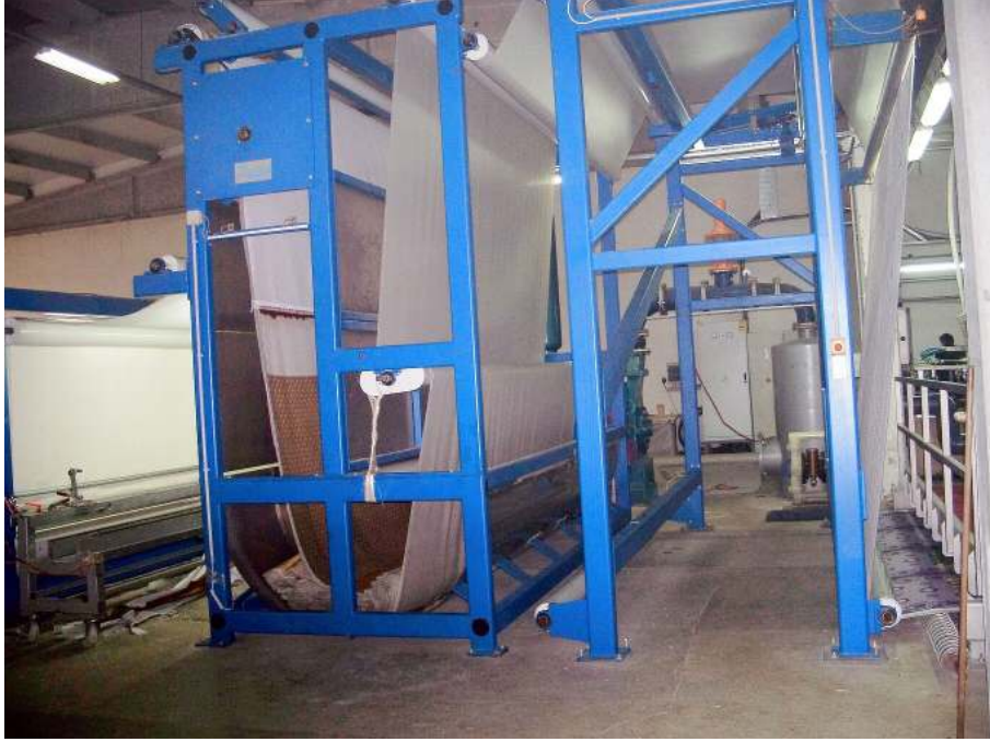
Fotoğraf 111: Büyük Baskı Makinesi Basım Aşaması(Samur Halı Fabrikası Ankara)
