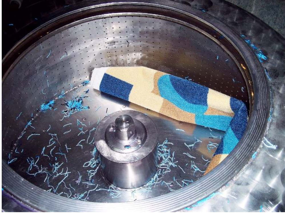
Fotoğraf 106 : Örnek Baskı Kurutma İşlemi(Samur Halı Fabrikası Ankara)
