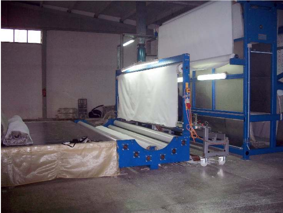
Fotoğraf 108: Büyük Baskı Makinesi(Samur Halı Fabrikası Ankara)
