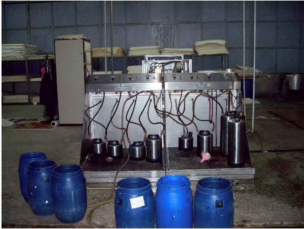
Fotoğraf 102: Örnek Baskı Makinesi Boya Tankı(Samur Halı Fabrikası Ankara)
