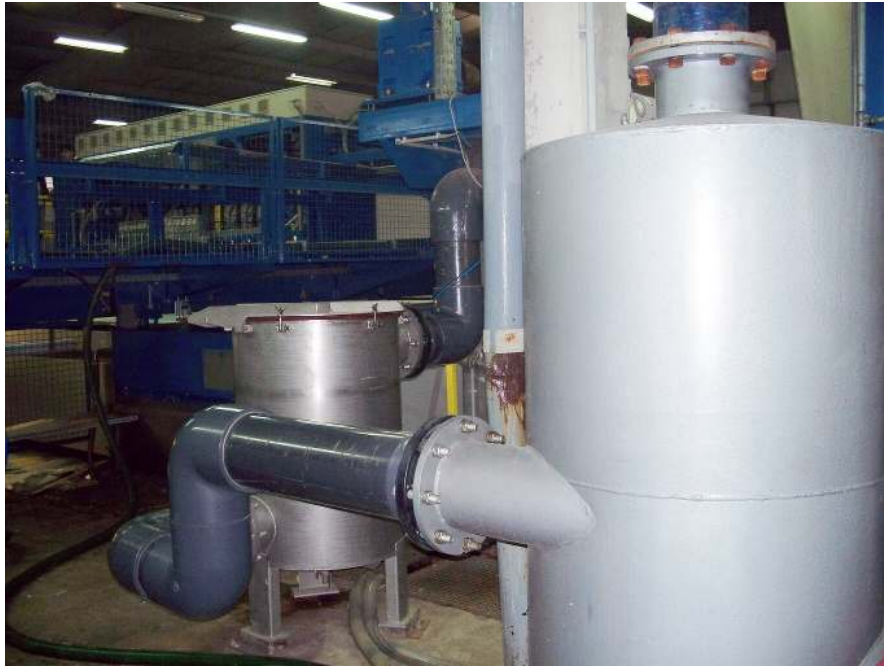
Fotoğraf 110 : Büyük Baskı Makinesi Boya Tankı(Samur Halı Fabrikası Ankara)
