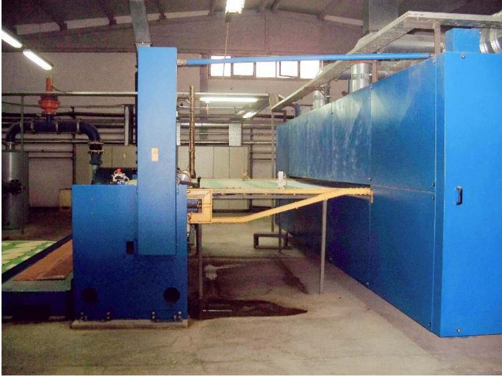
Fotoğraf 116 : Büyük Baskı Makinesi Kurutma İşlemi(Samur Halı Fabrikası Ankara)
