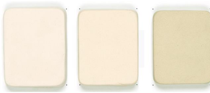
Görsel 3.16. Stoneware vakumlu Çamur. Sırası ile soldan sağa 1000 °C, 1100 °C, 1200 °C. (http-44)
