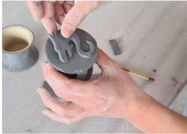
Görsel 4.21. Porselen döküm fincan rötuşlama aşaması, Sonay Ersöyleyen fotoğraf arşivi
