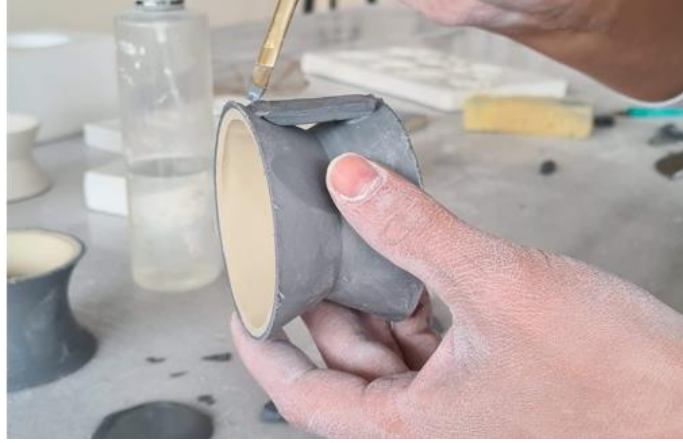
Görsel 4.19. Porselen döküm fincan rötuşlama aşaması, Sonay Ersöyleyen fotoğraf arşivi.
