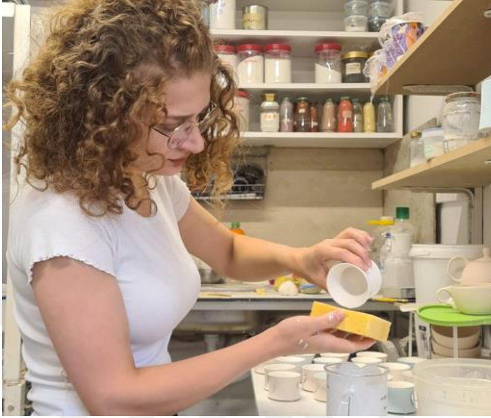
Görsel 4.27. 1000°C bisküvi pişirimi yapılan formların 1200°C sır ile sırlanma aşaması, Sonay Ersöyleyen fotoğraf arşivi
