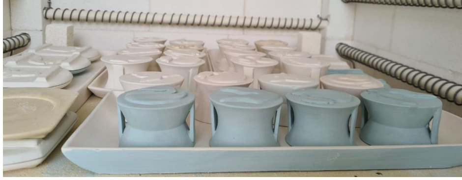
Görsel 4.22. Formların fırınlama aşaması, 1200°C, Sonay Ersöyleyen fotoğraf arşivi
