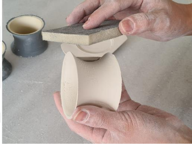
Görsel 4.20. Porselen döküm fincan rötuşlama aşaması, Sonay Ersöyleyen fotoğraf arşivi.
