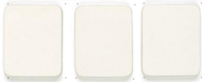
Görsel 3.17. Porselen vakumlu çamur, sırası ile (soldan sağa) pişirim dereceleri; 1200 °C, 1240 °C, 1280 °C. ( http-45 )
