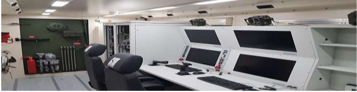
Şekil 2.2. Yer Kontrol İstasyonu
