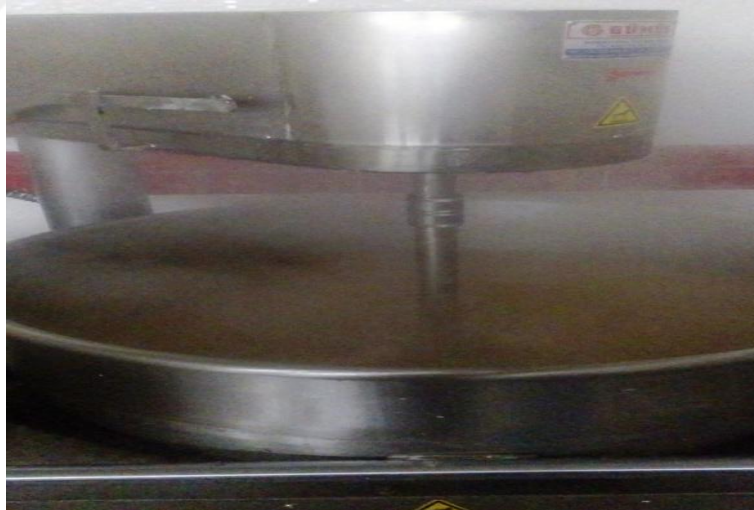
Resim 3.2 Lokum üretim kazanı (Gümüş, Türkiye 100 kg ürün kapasiteli, krom nikel kalite, hidrolik yapıda kolay boşaltma sağlayabilen, çift devirli karıştırıcılı ve karıştırma hızı 30-60 D/ D).
