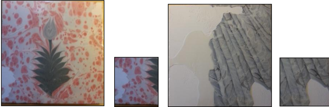
Şekil 3.12. Sır denemeleri esnasında meydana gelen uyumsuzluklar
