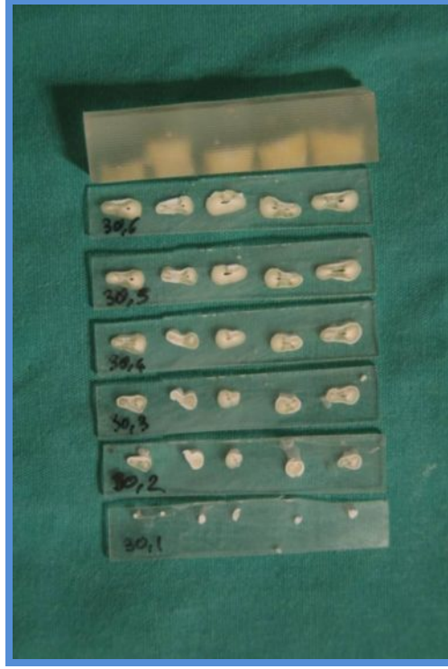
Şekil 3.11 Akril içerisine gömülen köklerden alınan kesitler
