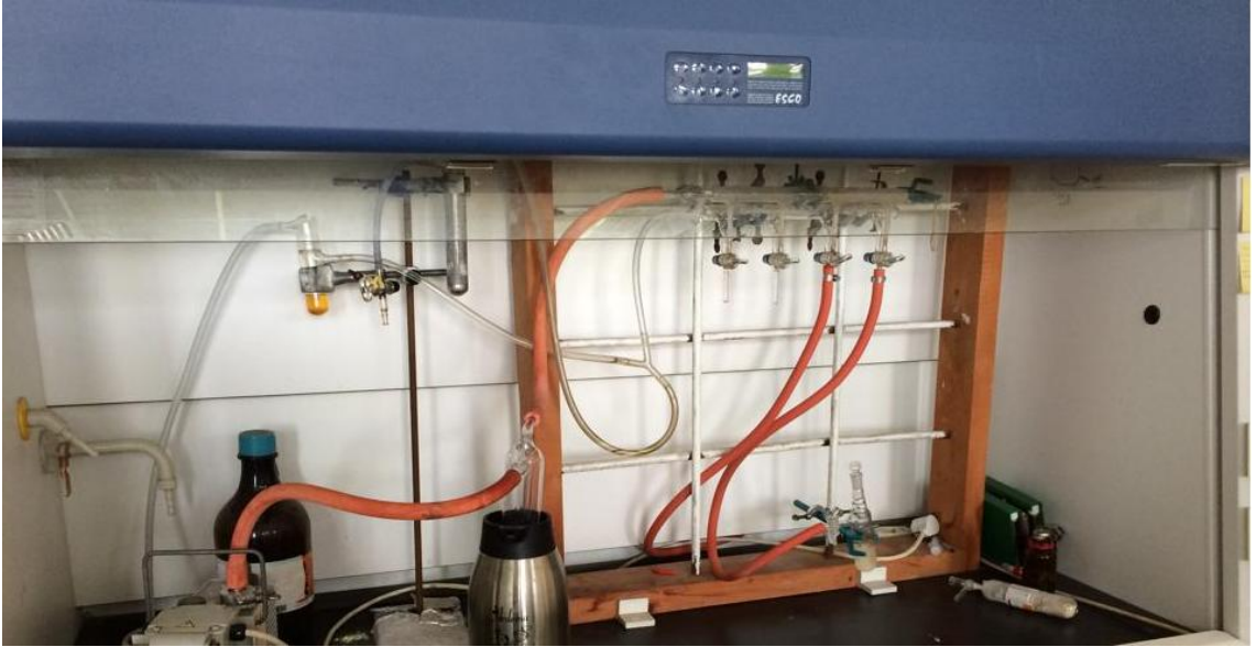
Şekil 3.5: Etil asetat fazın argon gazı ile ve vakum altında uçurulması
