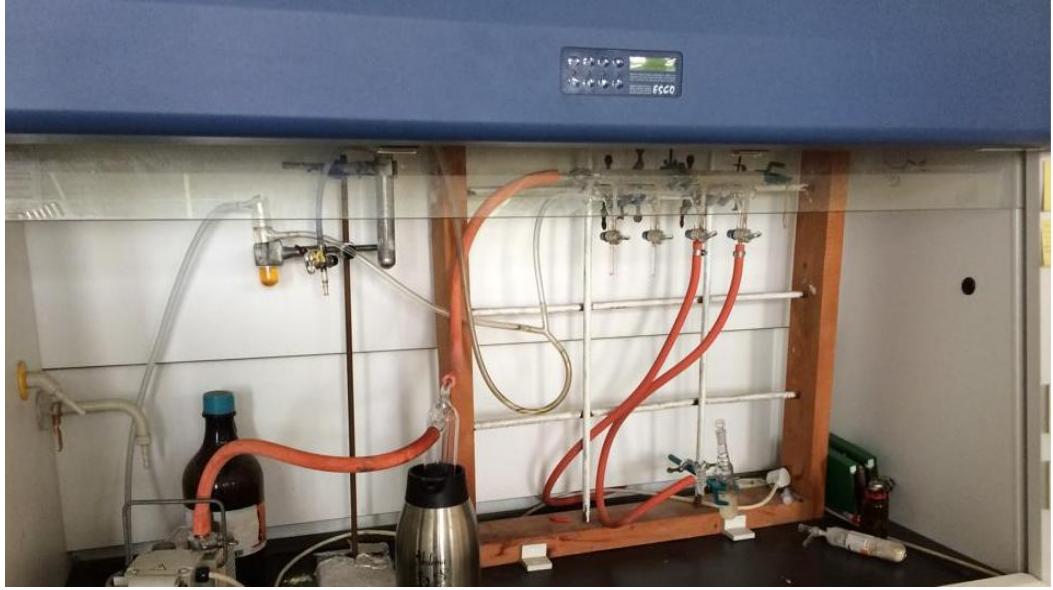
Şekil 4.21: Argon gazı altında etil asetat fazın uçurulmasına ve piknogenol bileşenlerinin toplanmasına ilişkin düzenek.
