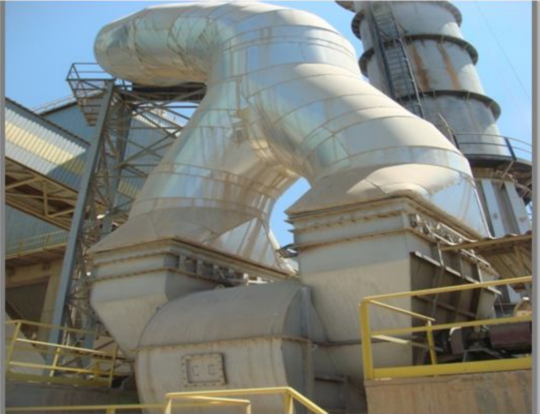
Foto 14: Döner Fırın Siklonları (1.Siklon) (Siklon=Ön Isıtıcı)
