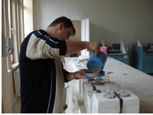
Resim 105: Kalıplara döküm aşaması.
