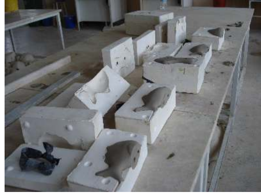
Resim 106: Kalıplardan çıkan ürünler.
