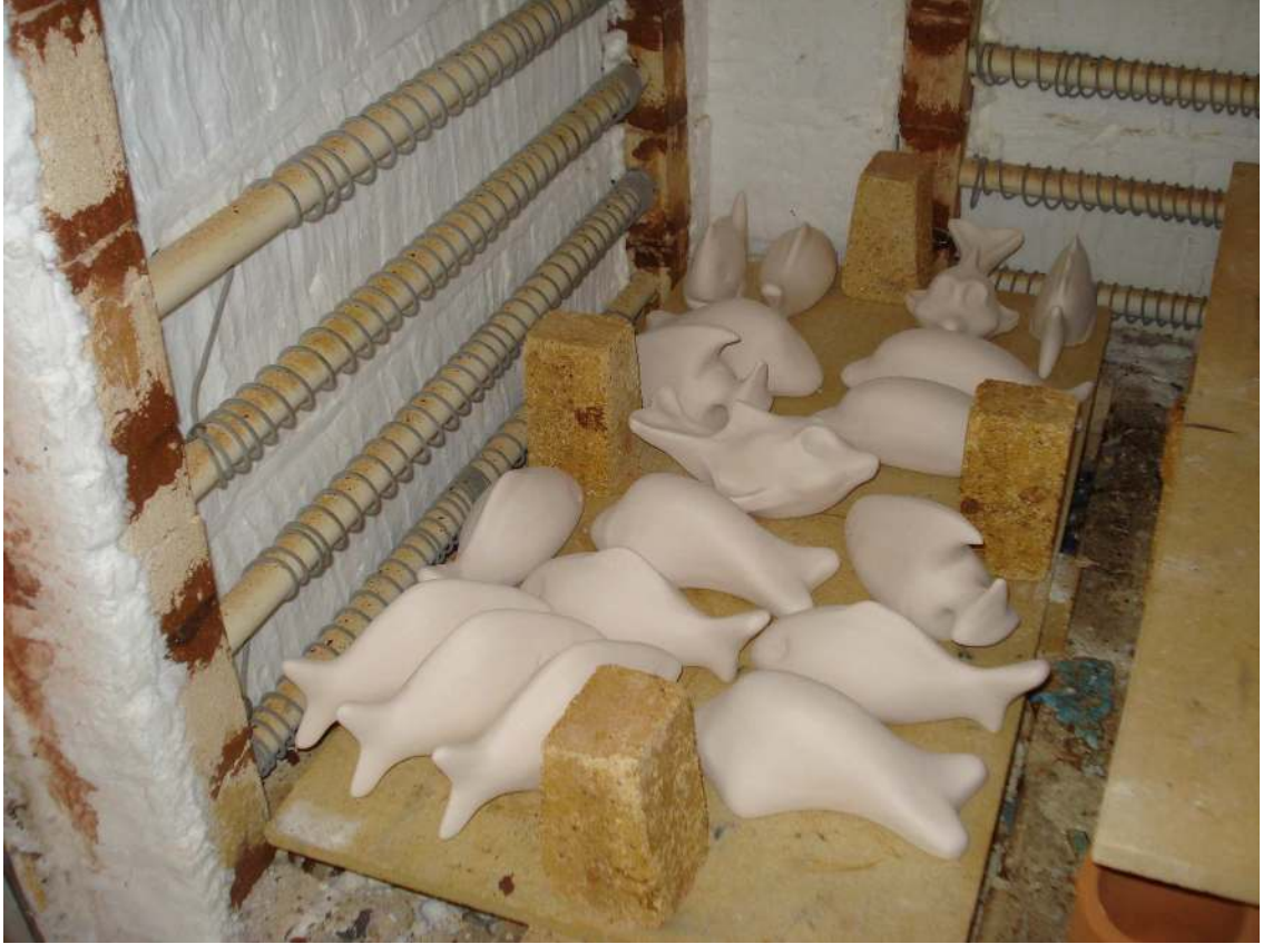
Resim 108: Bisküvi pişirimi yapılmış ürünler.
