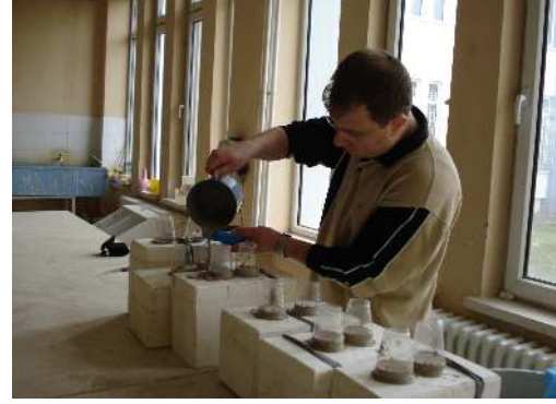
Resim 105: Kalıplara döküm aşaması.
