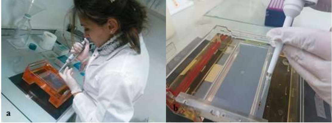
Şekil 3.12.a) DNA örneklerinin jele yüklenmesi; b) PZR örneklerinin jele yüklenmesi
