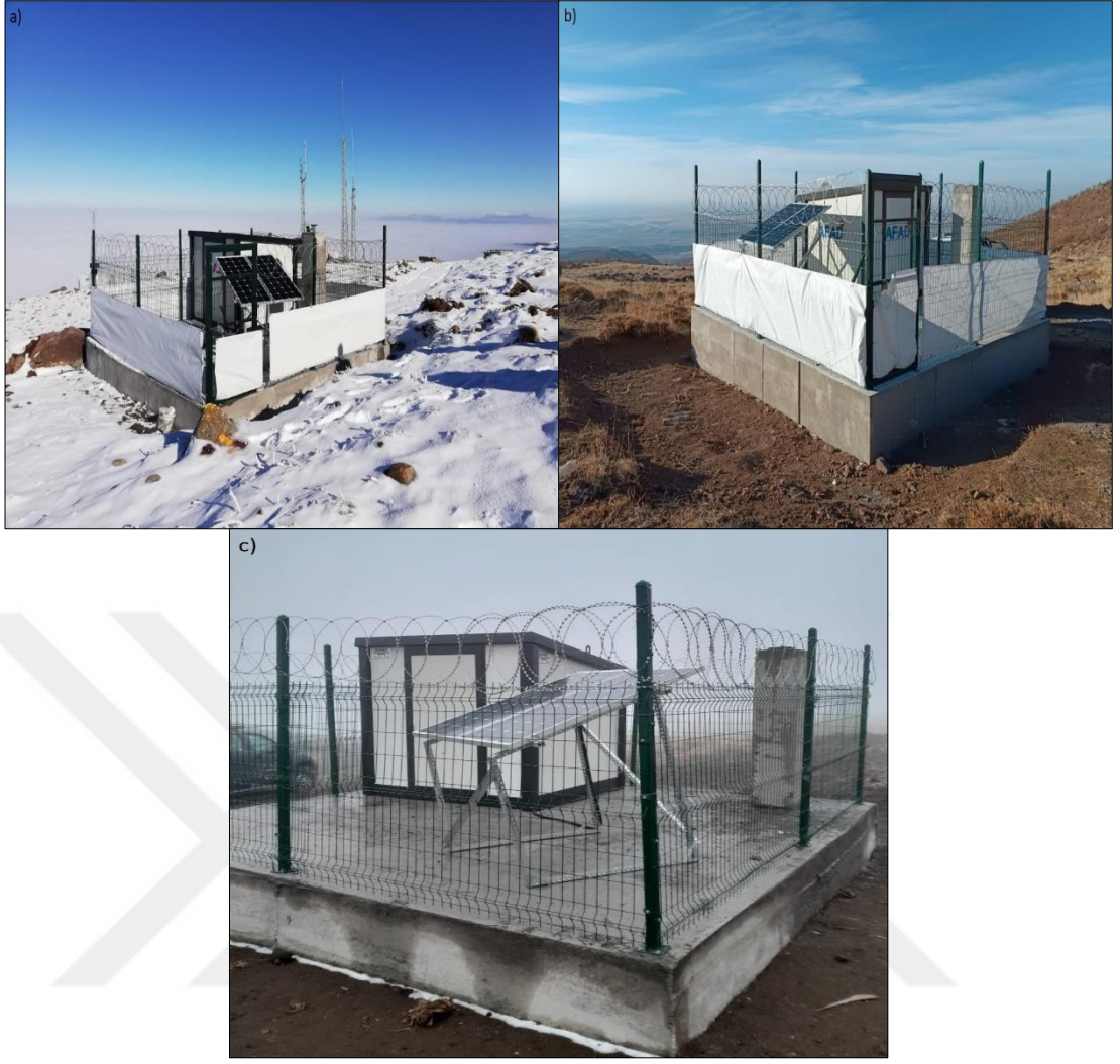
Şekil 4.3. Tesisi tamamlanan THKA-HAS-1 (a), THDI-HAS-2 (b) ve THKR-HAS-3 (c) sabit GNSS istasyonları.
