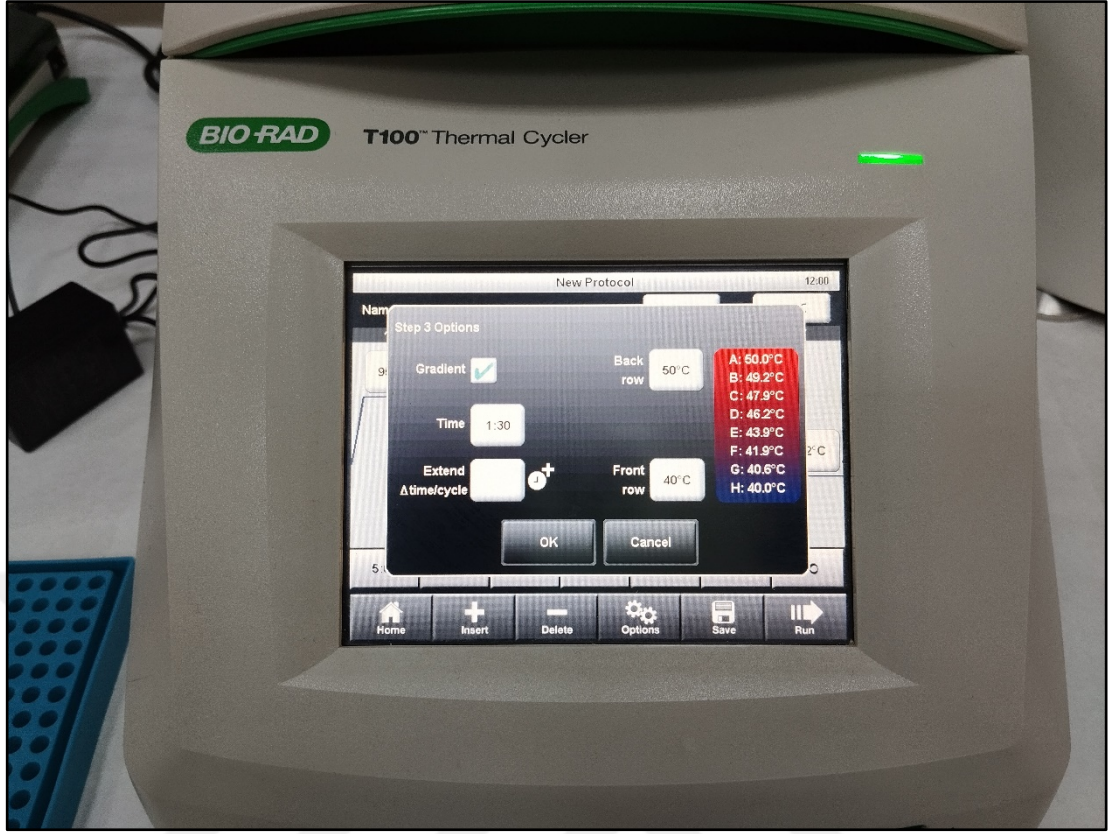
Şekil 7. Gradyent PCR için kuyucuk sıcaklıkları (A-H arası)
