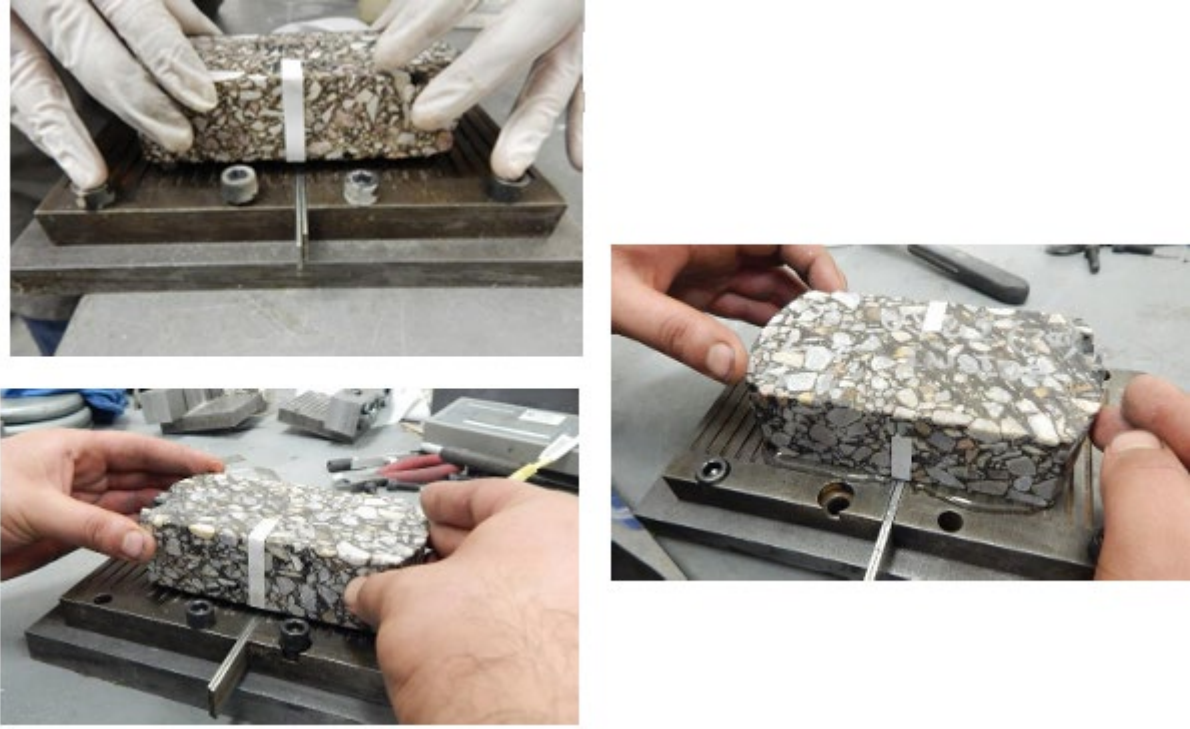
Şekil 4.5: Bindirme Tabakası test numunelerinin plakalar üzerine yerleştirilmesi
