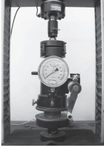
Şekil 3.14: Hveem stabilometre cihazı ve şematik taslağı
