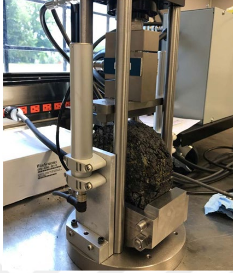
Şekil 4.15: IDEAL-RT deney cihazı
