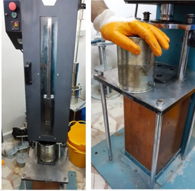
Şekil 3.19: Marshall numunesinin sıkıştırılma aşaması
