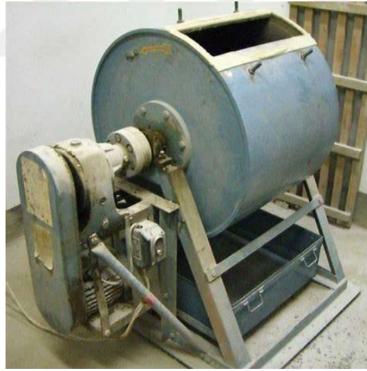
Şekil 4.19: Los Angeles aşınma test cihazı
