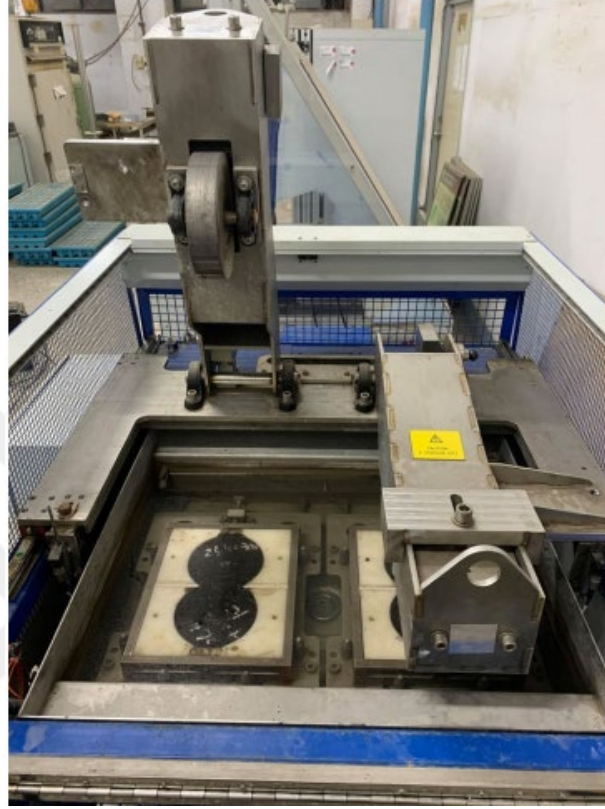
 ekil 4.12: Hamburg tekerlek izi testi
