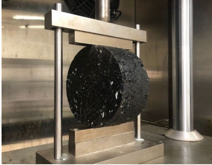
Şekil 4.10: Dolaylı çekme asfalt çatlama testi (IDEAL-CT)
