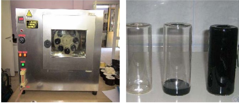
Şekil 3.25: Dönel ince film etüvü ve deney öncesi ve sonrasında şişelerin durumu
