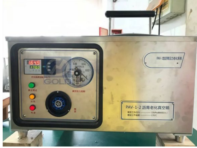
Şekil 3.26: Basıncı yaşlandırma deney cihazı
