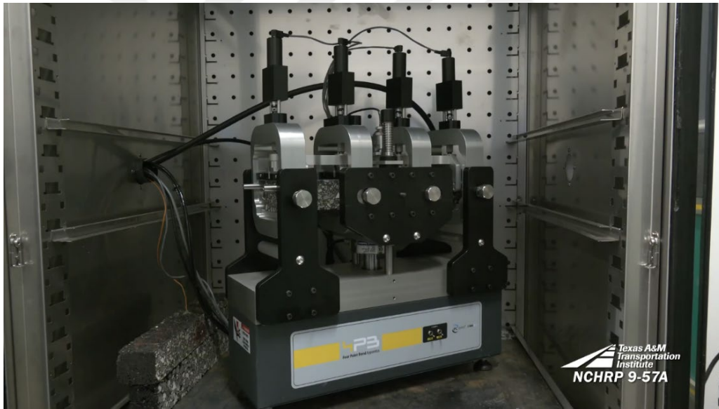
Şekil 4.8: Kiriş eğilme yorulma test cihazı
