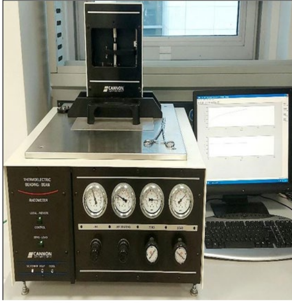
Şekil 3.29: BBR deney cihazı ve numunenin yük-yer değiştirme şeması
