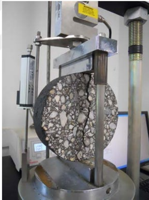
Şekil 4.7: N_{Flex} faktörü testi
