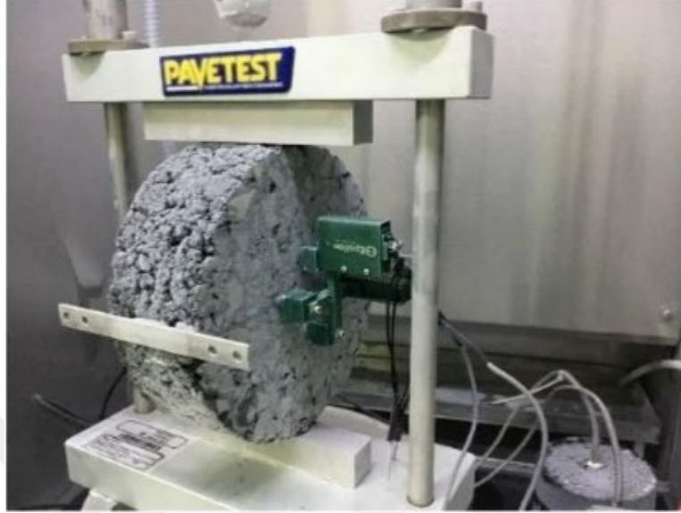
Şekil 4.4: IDT sünme uyumluluğu ve dayanım testi
