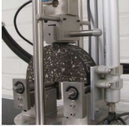
Şekil 4.2: Illinois esneklik endeksi testi
