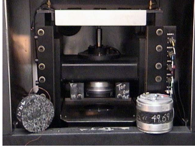
Şekil 3.40: Kesme cihazı plaka yapıştırma bölümü
