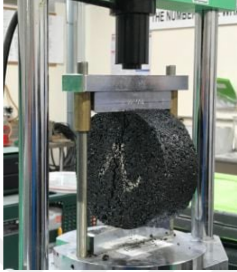
Şekil 4.18: Dolaylı çekme dayanımı test cihazı
