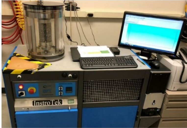
Şekil 4.16: Asfalt karışım performans test cihazı
