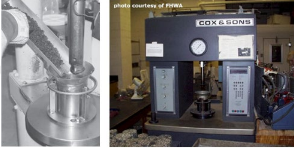
Şekil 3.13: Hveem test numunelerinin hazırlaması için California Yoğurma Kompaktörü
