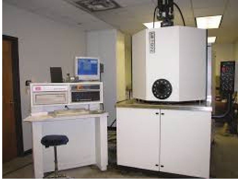
Şekil 3.39: Superpave kesme testi
