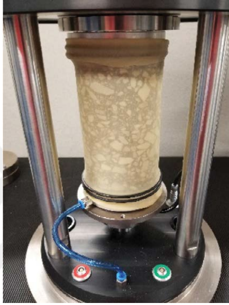
Şekil 4.17: SSR test numunesinin AMTP sistemine yerleştirilmesi
