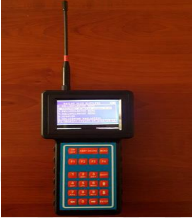
Şekil 3.18. AMR mobil uzaktan okuma el terminali (Muhammetoğlu 2017)
