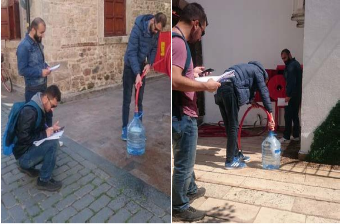
Şekil 3.54. Alt bölge (DMA) girişinde yüksek kotlu bir alanda ve deniz seviyesinde yangın dolapları açılarak debi ölçümü (Gulaydın 2017)
