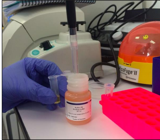
Şekil 3.5: DNA'ların Qiagen MinElute Gel Extraction Kit ile temizlenme aşaması; DNA üzerine eklenen Buffer PB'yi gösteren adım.
