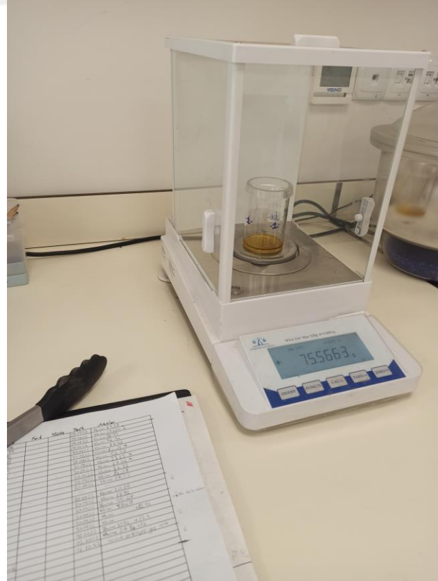
Fotoğraf 3.22. Hassas Terazi ile Yağ Ağırlığı Ölçüm İşlemi
