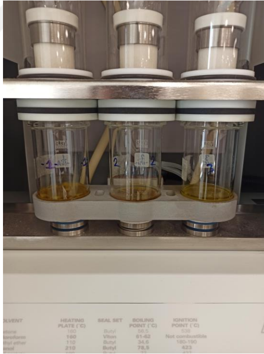
Fotoğraf 3.18. Soxhlet Ekstraksiyon Cihazı ile Yağ Elde Etme İşlemi-2
