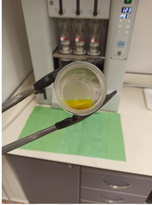
Fotoğraf 3.19. Soxhlet Ekstraksiyon Cihazı ile Elde Edilen Yağ
