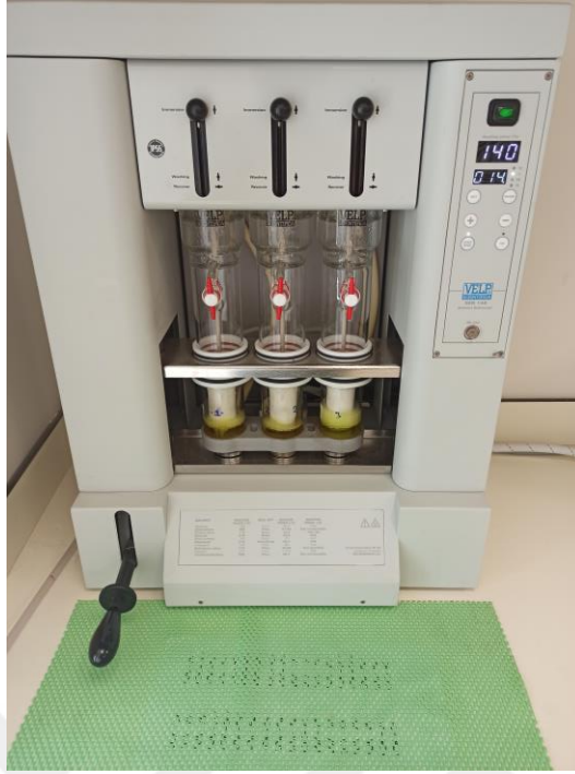
Fotoğraf 3.17. Soxhlet Ekstraksiyon Cihazı ile Yağ Elde Etme İşlemi-1
