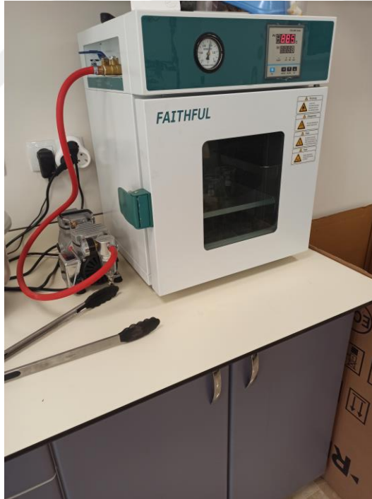
Fotoğraf 3.20. Negatif Basınçlı Etüv ile Hekzan Uzaklaştırma İşlemi
