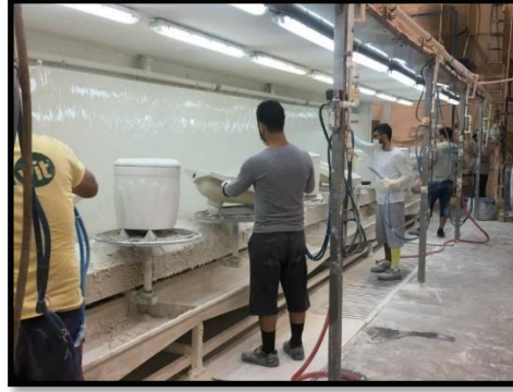
Fotoğraf 1.2. :Püskürtme yöntemi ile sırlama (elle)
