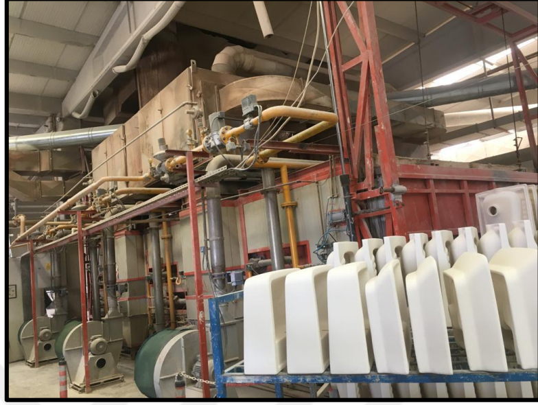
Fotoğraf 2.3. : Doğalgaz ile çalışan, 3600 ürün pişiren vitrifiye fırını
