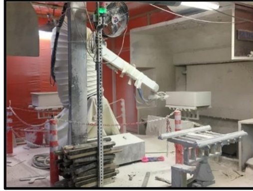
Fotoğraf 1.1. :Püskürtme yöntemi ile sırlama (otomatik)
