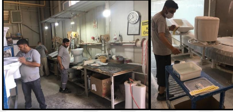
Fotoğraf 1.4. : Seramik sağlık gereçlerinin kalite kontrol ve markalama aşamaları Kaynak: Diyarbakır'daki seramik sağlık gereçleri fabrikasında Zehra OBUT BİLİM tarafından çekilmiştir.
