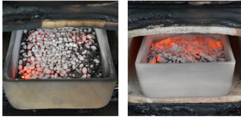
Görsel 2.6. Seramik fırınında küllerin kalsine edilmesi (Başaran, 2019)
