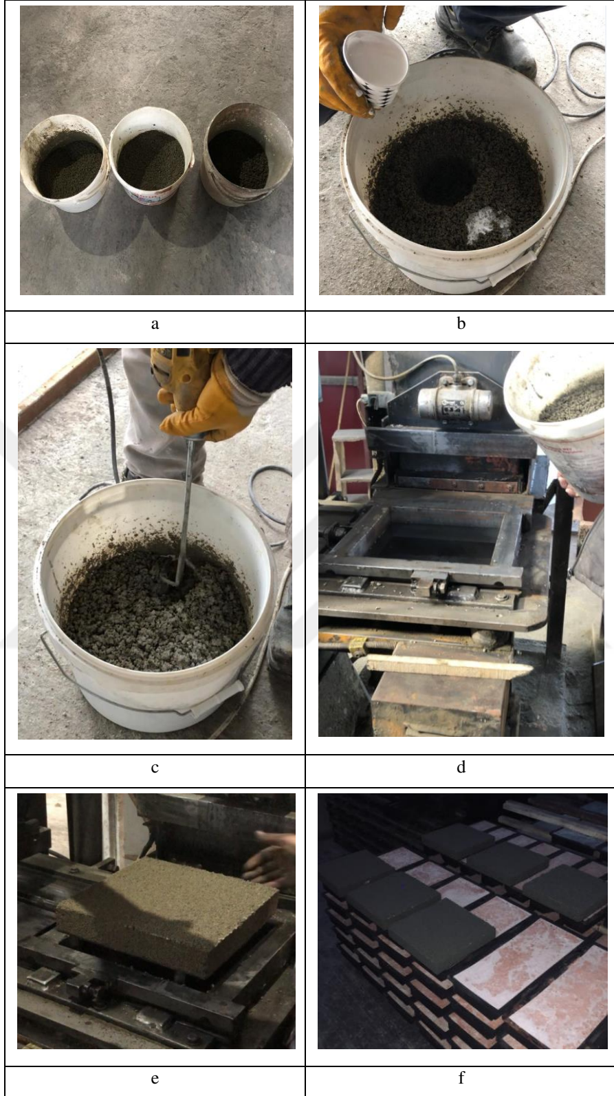
Şekil 24. FDM'li ve FDM'siz pomza blok örneklerinin hazırlanma aşamaları (a) pomza agrega ve çimento karışımlarının hazırlanması, (b) FDM'nin eklenmesi, (c) karışımın karıştırılması, (d) kalıba dökülmesi, (e) vibrasyonlu hidrolik press makinesinde şeklinin verilmesi, (f) örneklerin kurumaya bırakılması
