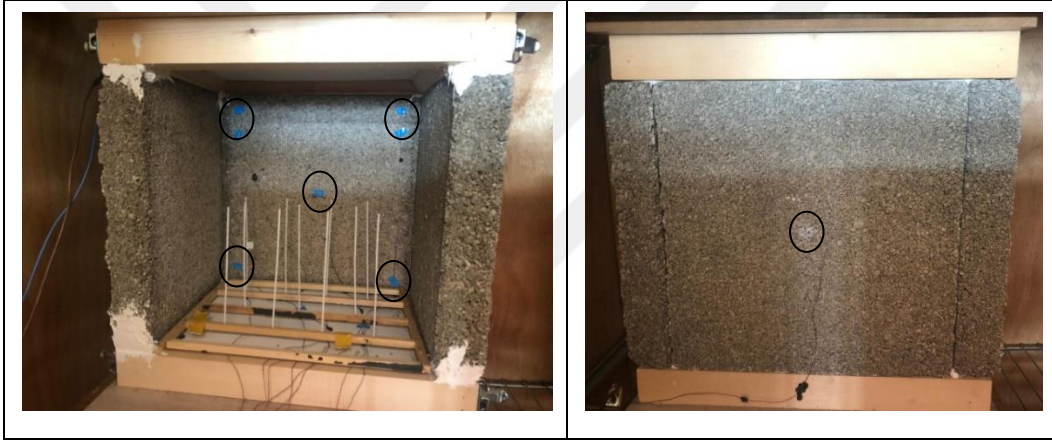
Şekil 30. Kontrol odasındaki uygulamada mini kabin içerisine ve dışına yerleştirilen ısıl çiftler
