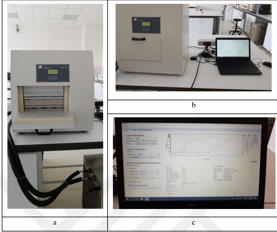
Şekil 20. (a) Örneklerin ısı iletkenlik katsayılarının belirlenmesi, (b) ve (c) Ölçümlerin bilgisayar programında grafiksel olarak takip edilmesi
