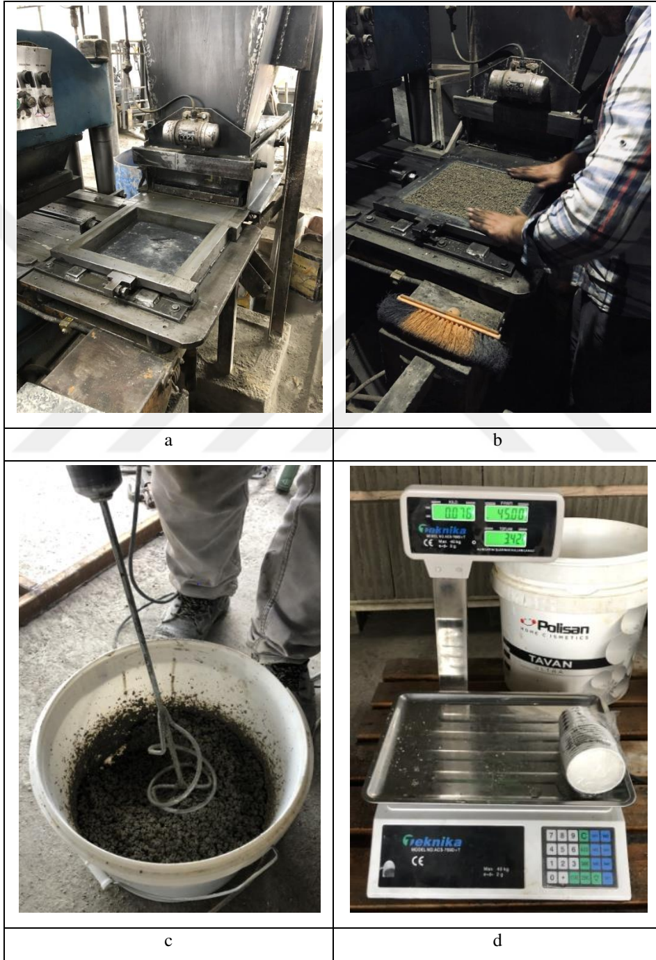
Şekil 17. (a)Vibrasyonlu hidrolik press makinesi, (b) 30cmx30cmx5cm boyutlarında hazırlanan kalıp, (c) harç karıştırıcı ve (d) elektronik hassas terazi görünüşü
