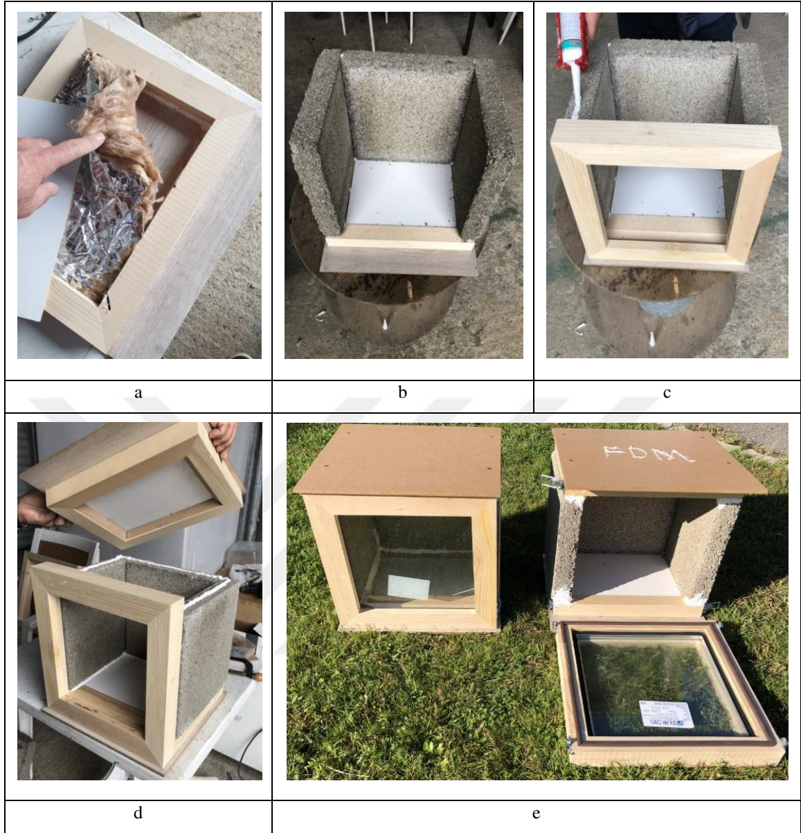
Şekil 26. Mini kabinlerin yapılma aşamaları (a) zemin ve çatı paneline yalıtımın yerleştirilmesi, (b) pomza blokların zemine sabitlenmesi, (c) ahşap çerçevenin takılması, (d) çatının yapıştırılması, (e) hazırlanan referans ve FDM'li kabinlerin görünüşü
