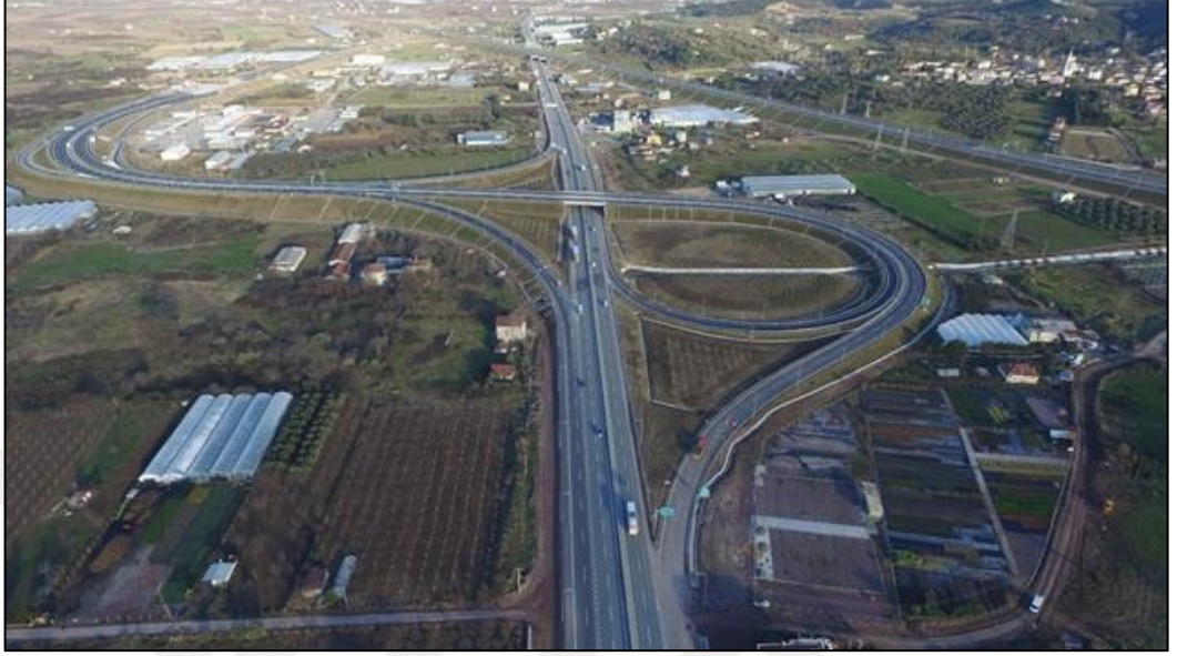
Şekil 3.37. Trompet kavşak örneği.
