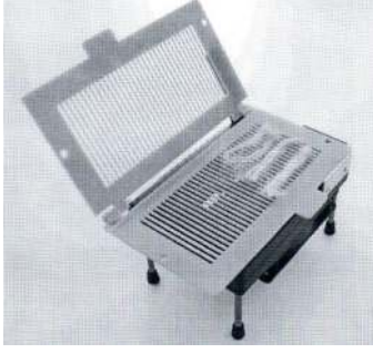
Resim 3. 5. Elyaf numunesini yerleştirme slaytı, fanın üstünde (OFDA 2000 Reference Manual, 2001)
