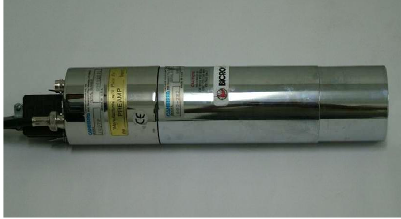
Şekil 3.5. Kullanılan NaI(Tl) dedektör (Ün,2007).
