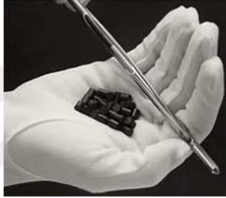
Şekil 2.7. Yakıt peletleri ve yakıt çubuğu
