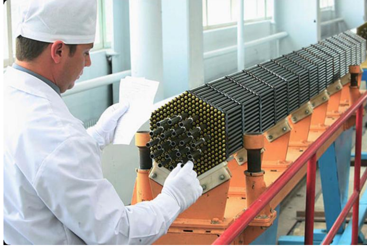
Şekil 3.13. VVER yakıt demeti
