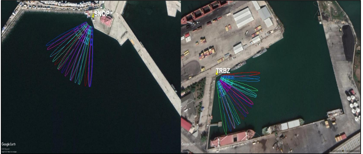
Şekil 49. Mareograf ortak yerleşkeli SNOP ve TRBZ sabit GNSS istasyonları Fresnel bölgeleri
