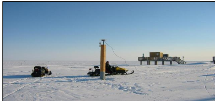
Şekil 29. Kar kalınlığı belirlenmesinde GNSS-IR (URL-18, 2022)
