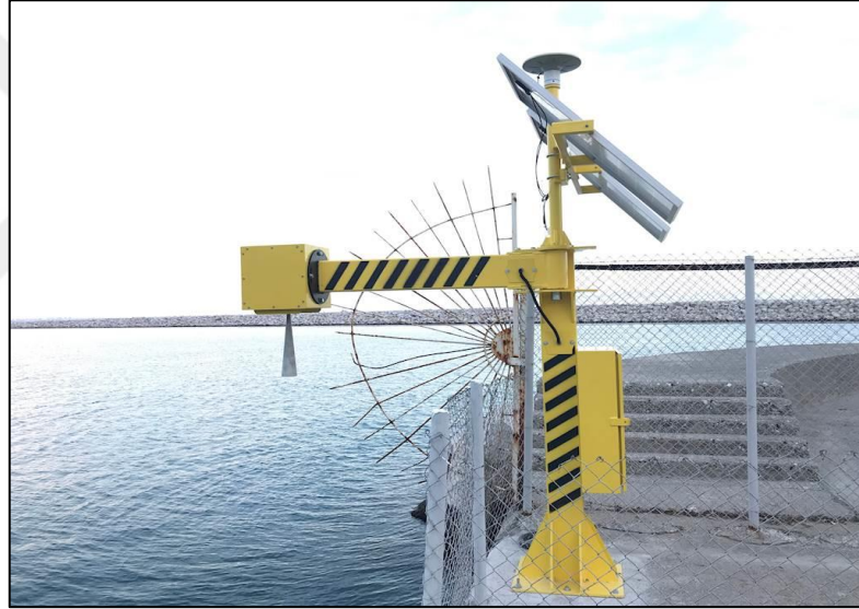
Şekil 5. Radar sensörlü mareograf istasyonu (URL-7, 2022)
