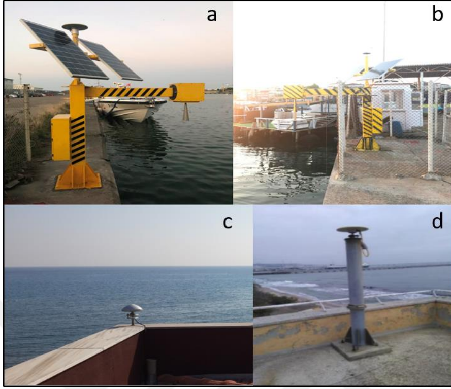
Şekil 55. GNSS-IR ile deniz seviyesi değişimi belirlemeye uygun istasyonlar. TRBZ (a) ve SNOP (b) (URL-19, 2022), MERS (c) (URL-17,2022) ve TEKR (d) sabit GNSS istasyonları
