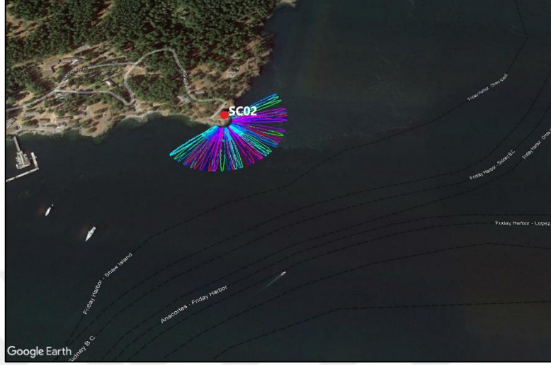
Şekil 78. SC02 istasyonu Fresnel bölgesi
