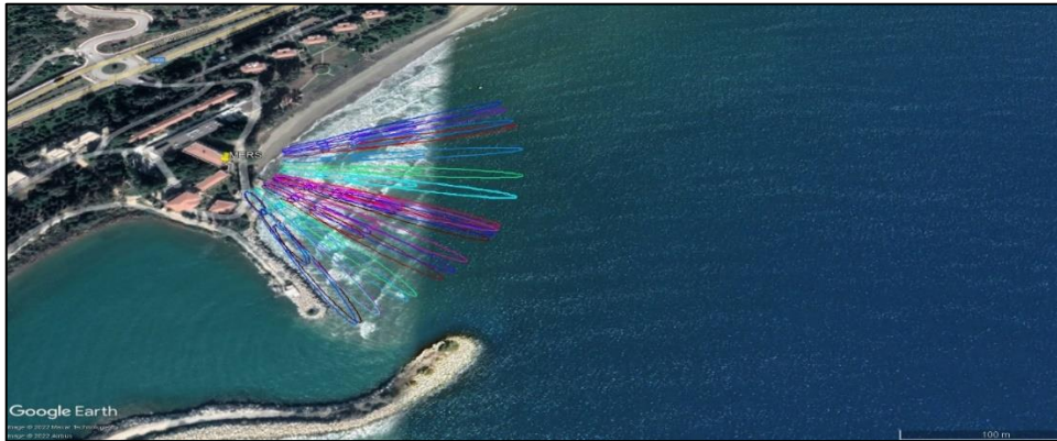
Şekil 48. MERS sabit GNSS istasyonu Fresnel Bölgesi
