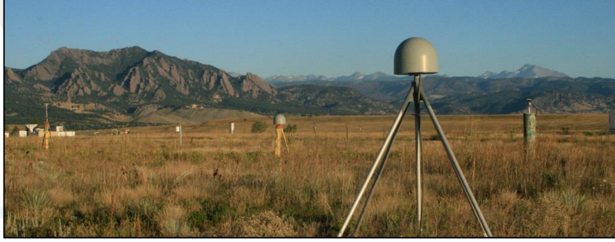
Şekil 30. Toprak neminin belirlenmesinde GNSS-IR (URL-18, 2022)
