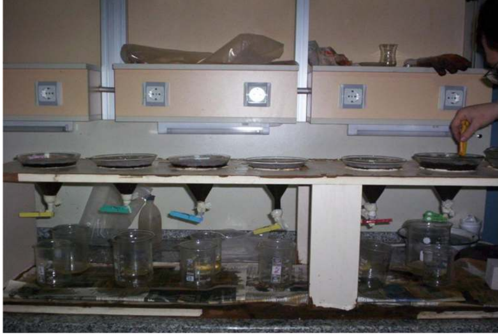
Şekil 3.28 0,355/0 mm tane aralığı yüzdürme-batırma testi yapılışı
