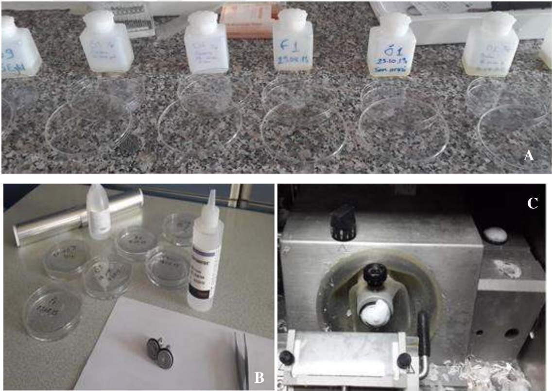
Şekil 2.11. OCT ile direk kesit alma işlemi.
