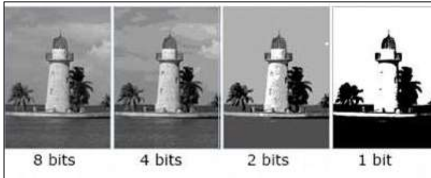
Şekil 2.7 Bit sayısına göre radyometrik çözünürlüğün gösterimi (URL-4)
