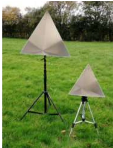
Şekil 2.26 Radargrametride kullanılan köşe yansıtıcıları (URL -8)
