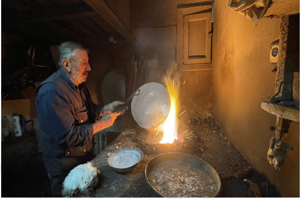
Görsel-6:Bakır kalaylama işlemi.
