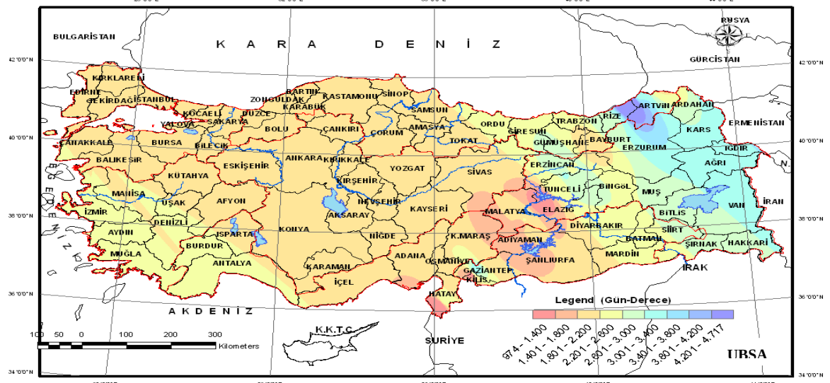
Şekil 4.3. 18 °C denge noktası sıcaklığında DMİ, YSA ve UBSA verileri ile hesaplanan IDG sayıları Türkiye haritası üzerinde renkli gösterimi
