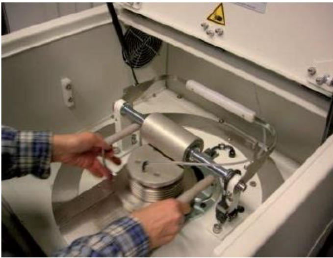
Şekil 5.7 Artık gaz ölçümünde kullanılan değirmen.
