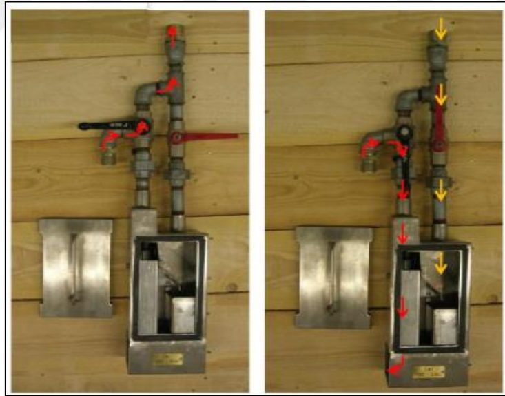
Şekil 5.3 Vakum ile numune almayı sağlayan ejektör kutusu.
