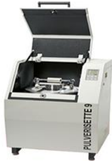
Şekil 5.7 Artık gaz ölçümünde kullanılan değirmen.
