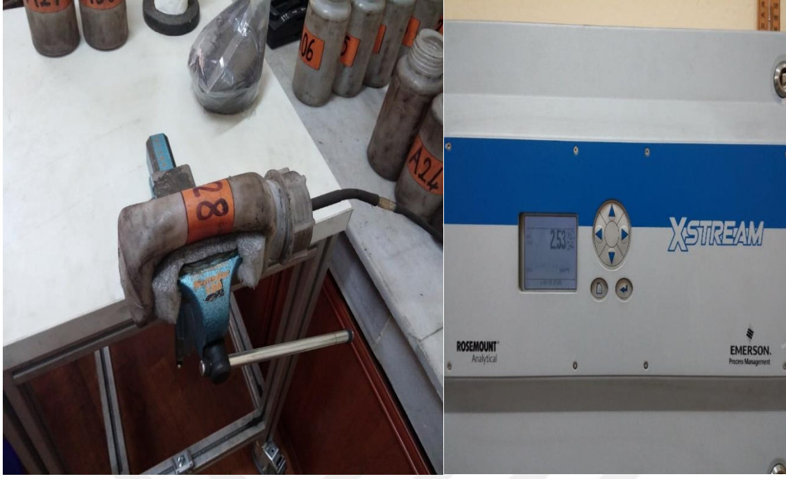
Şekil 5.6 Yayılan gaz miktarının ölçülmesi.
