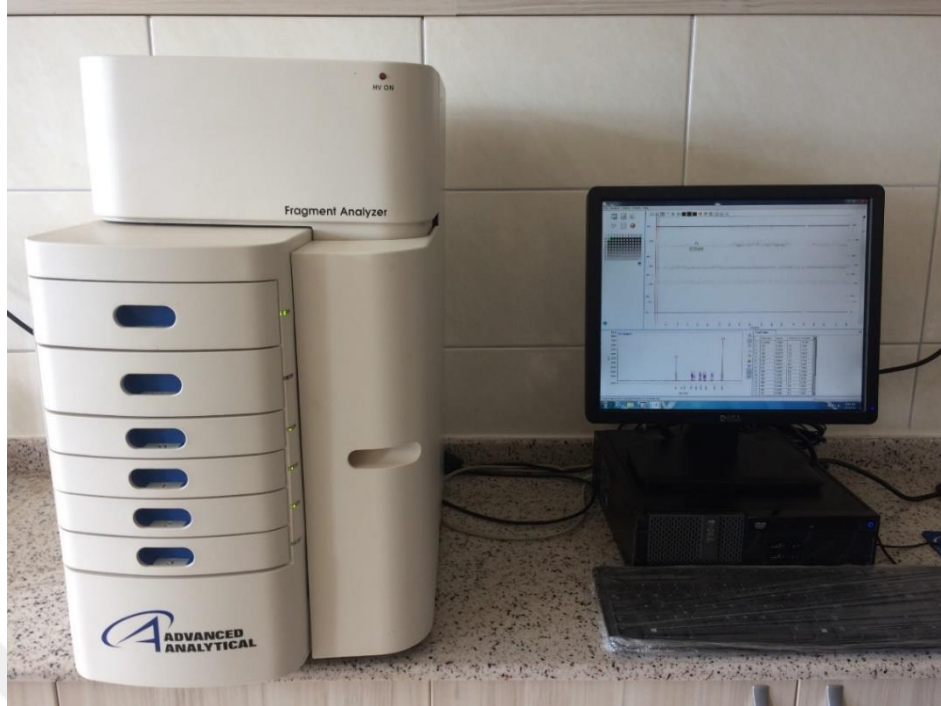
Şekil 3.3. PCR ürünleri için fragment analiz cihazı
