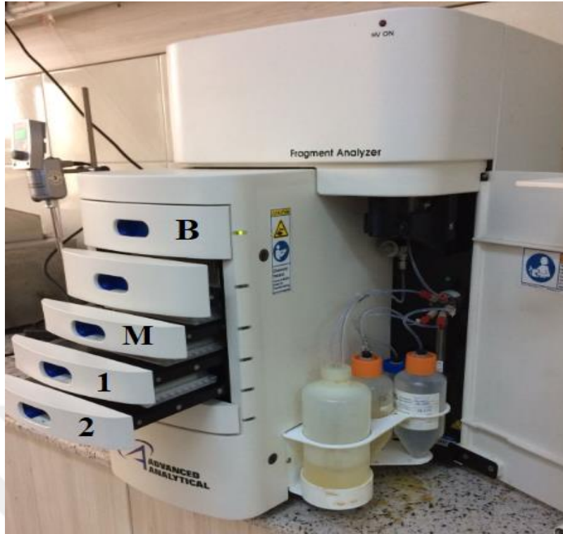
Şekil 3.5. Fragment analizi için cihazın hazırlanması
