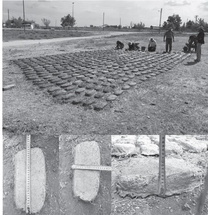
Resim 2.7. Deneysel Kerpiç Boyutları ve Kerpiç Yapımı
