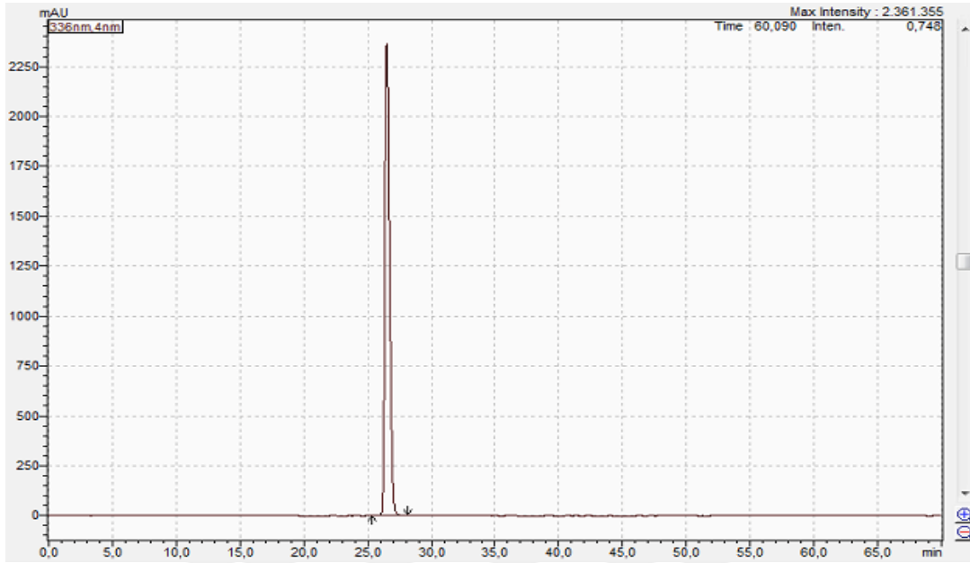
Şekil 4-4: Klorojenik asit standartına ait LC kromatogramı
