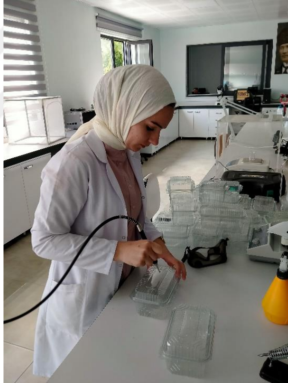
Şekil 3.12. 1000 cc'lik plastik kaplarının üzerinde lehim aletiyle delikler açılması
