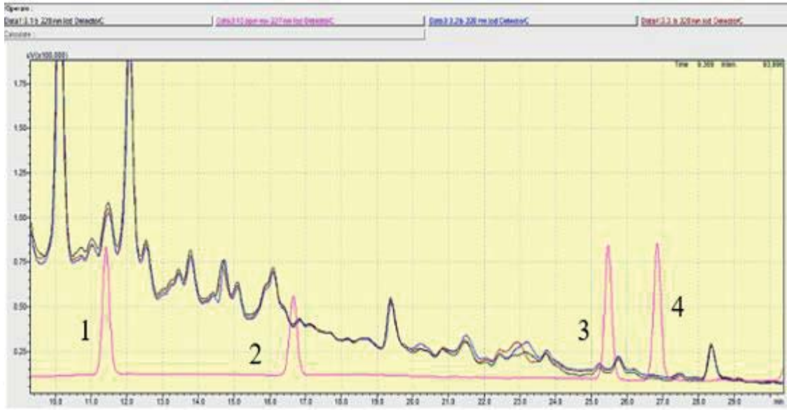
Şekil 4.3: 10 - deasetil bakkatin III' ün en çok tespit edildiği Ham fıncığının sert kabuk kromatogramı. Pembe pikler: 10 mg/L standart çözeltisi; 1: 10- deasetil bakkatin III (11-12 dk); 2:Bakkatin III (16-17 dk); 3 Sefalomanin (25-26 dk); 4: Paklitaksel (26-27dk). Üst üste siyah, mavi, mor pikler; Ham fıncığının sert kabuğunun 3 tekrarını göstermektedir.
