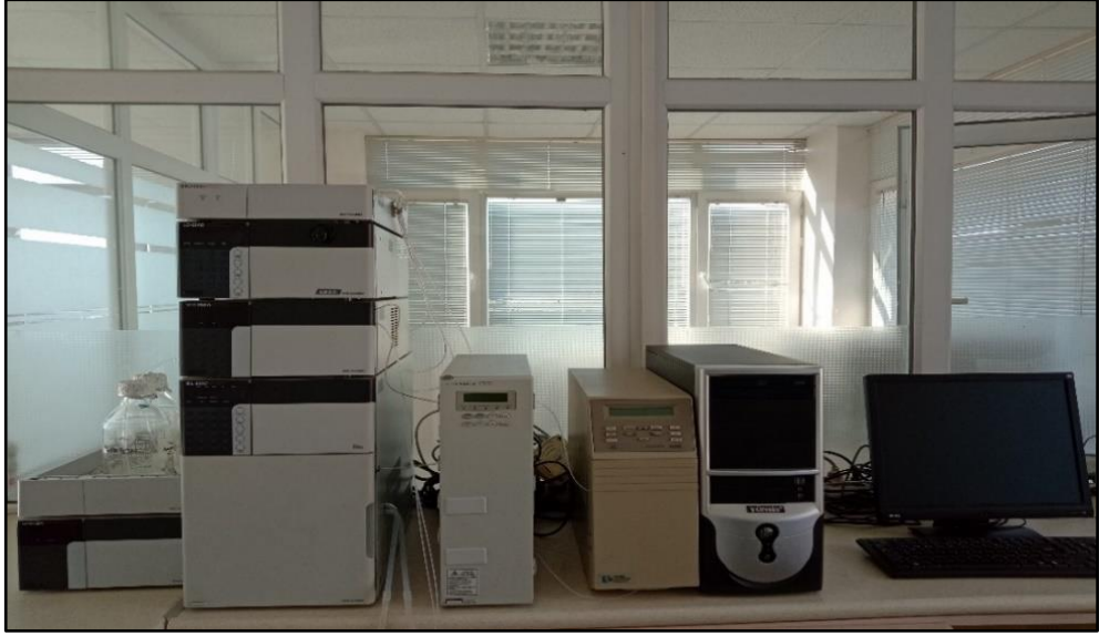
Şekil 3.5. Allisin analizi yapılan HPLC sistemi
