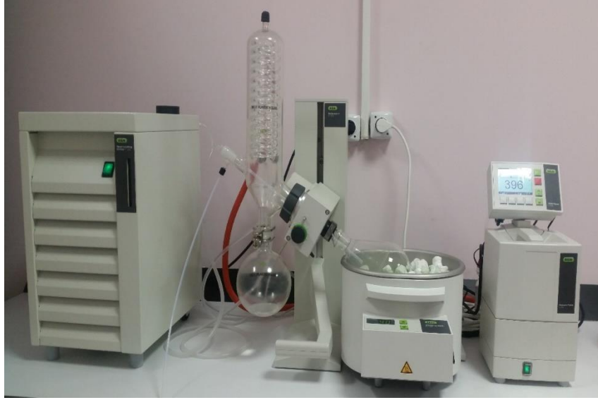
Şekil 3.2: Rotary evaporator cihazı ile ekstreten çözücünün uzaklaştırılması.
