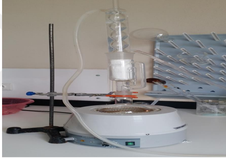
Şekil 3.1: Soxhlet cihazı ile ekstraksiyon işlemi.
