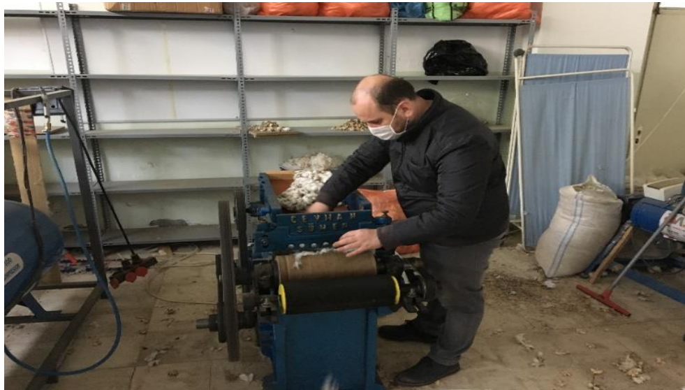
Şekil 3.17. Kütlü pamuklar çırçır makinesinden geçirilip lif ve çiğitlerine ayrılırken
