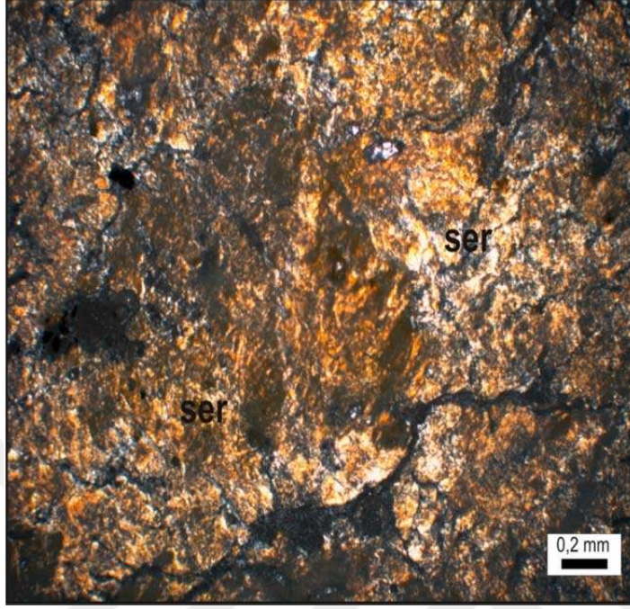
Şekil 4.7. T34 örneğine ait petrografik inceleme kayaç serpantinleşmiş
