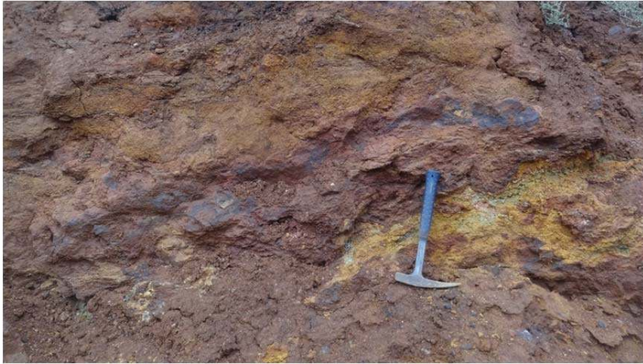
řekil 4.13. Cevherleşme içerisinde gözlenen hematitli, limonitli seviyeler
