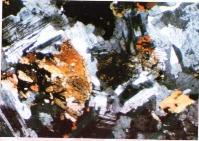
Şekil 2.9: Tersiyer Granitoidine ait kayaçların mikroskopta görünümü. Çapraz nikol. Büyültme 32x10.
