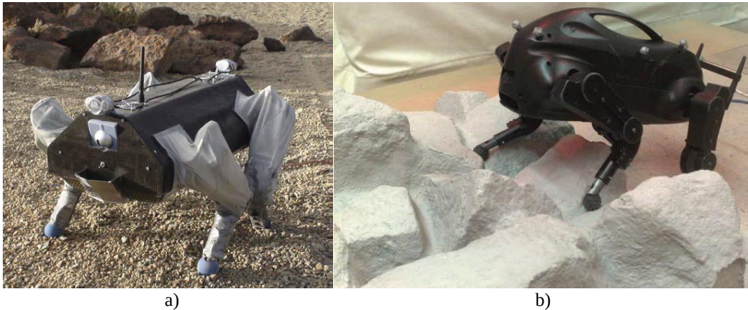
Şekil 2.3. Dört ayaklı robotların arazideki yürüyüşleri a) ALoF, b) LittleDog
