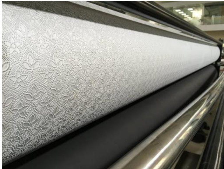
Şekil 4.10. Tuvalet kağıtlarında gofraj baskısının yapılması için kullanılan silindirlere örnek verilmektedir.
