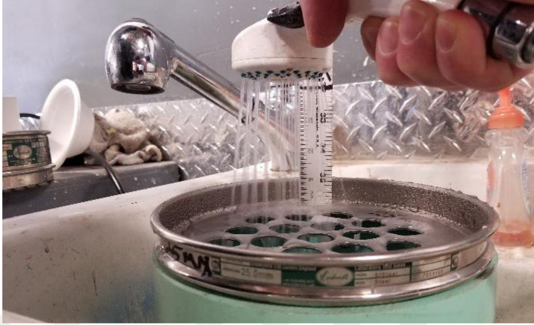
Şekil 3.7. Slosh-box yönteminde kullanılan 25 mm gözenek çaplı ve yuvarlak delikli elekler ile bu eleğin debisi 4/L dakika olan bir duş kafası ile yıkanması sunulmaktadır.
