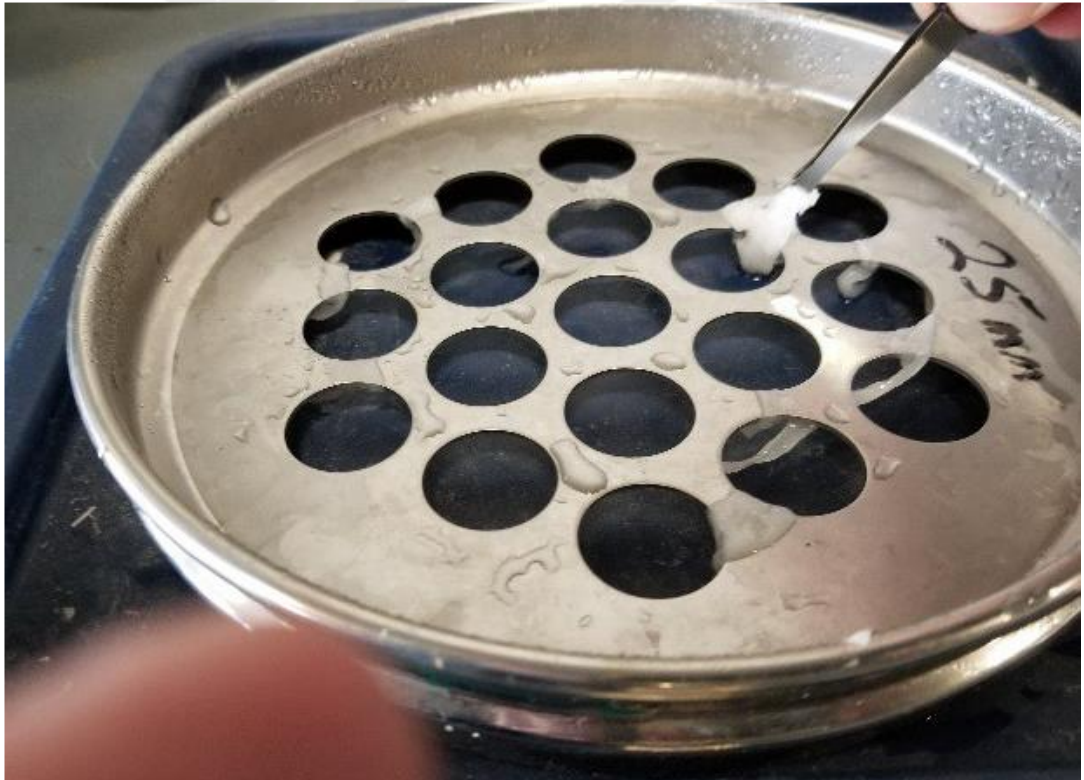
Şekil 3.8. Bir önceki resimde sunulan işlemten sonra elekte kalan parçacıkların cımbız ile toplanması gösterilmektedir.
