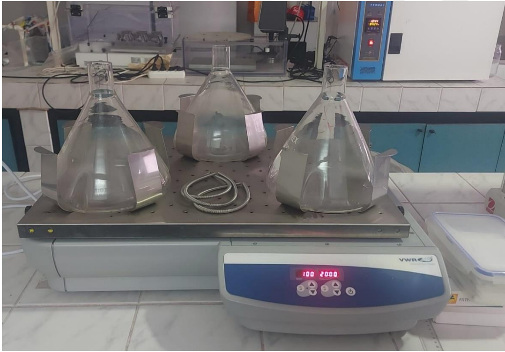
Şekil 3.1. Fiziksel parçalanma deneylerinde kullanılan 2.8 L Fernbach erleni ve orbital çalkalayıcı.
