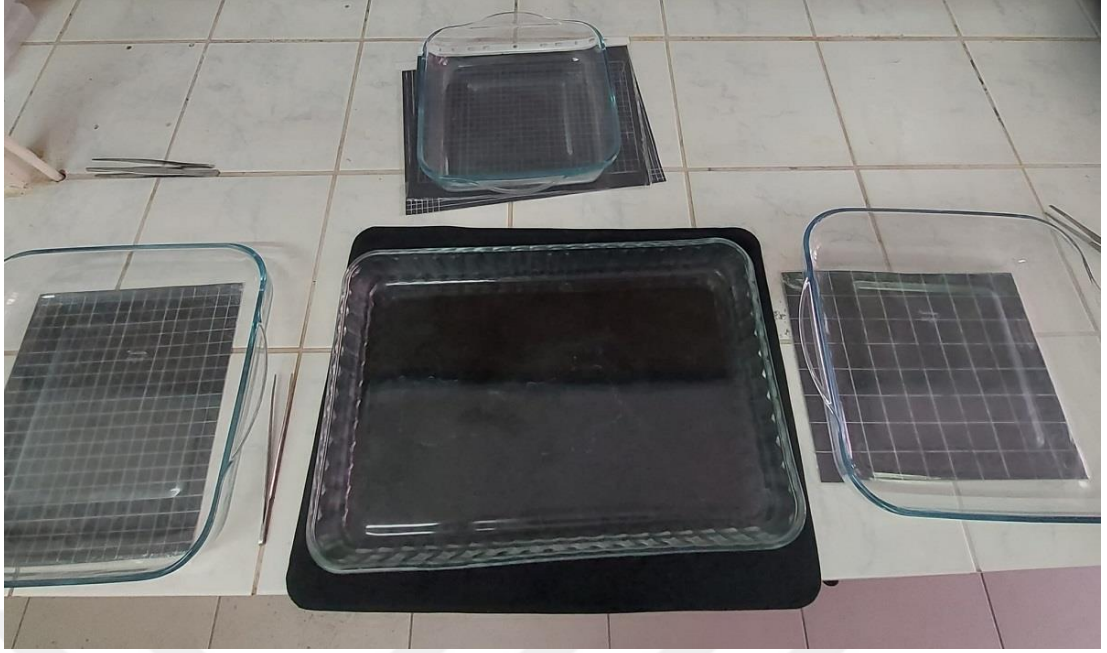
Şekil 3.4. Fiziksel parçalanma sırasında oluşan parçacıkların boyut analizlerinin yapılabilmesi için kullanılan yöntem.
