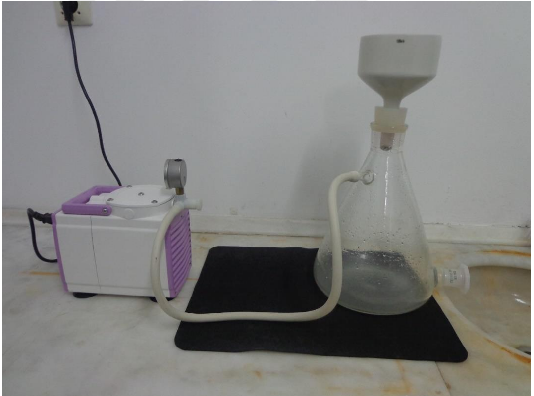
Şekil 3.5. Parçalanma sırasında oluşan katı parçacıkların ayrıştırılması için vakumlu filtrasyon sistemi.
