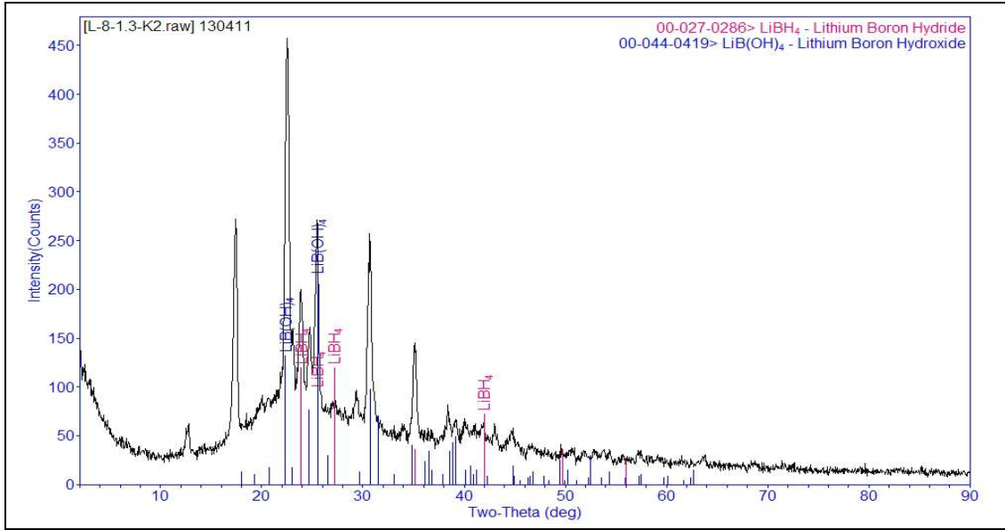
Şekil 4.45. LiBO 2 ile başlanan reaksiyon ürünü LiBH 4 XRD grafiği
