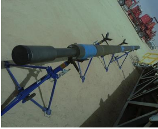
Şekil 4.22: Paker ve çatlatma test ünitesi.
