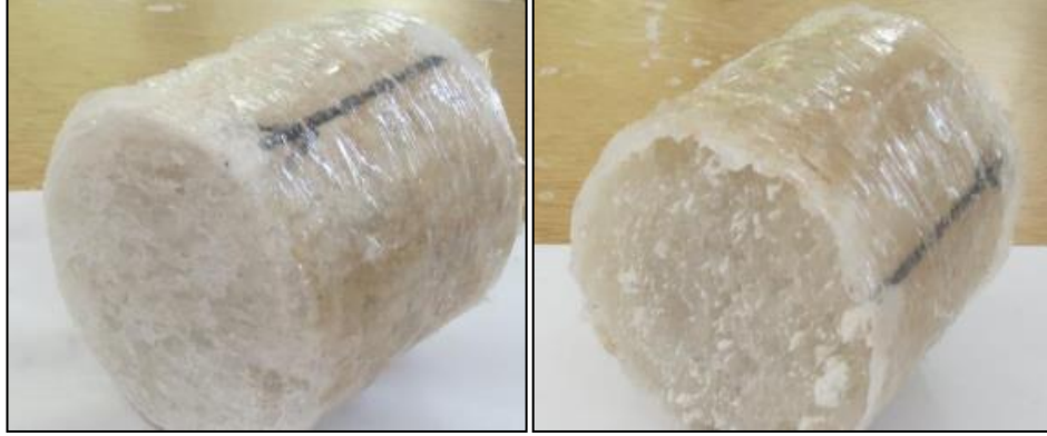
Şekil 5.4: Düşey çözünme hızı deneyi (METU, 2014a).
