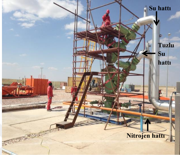
Şekil 4.13: Tuz eritme işleminde kullanılan tipik kuyu başı.
