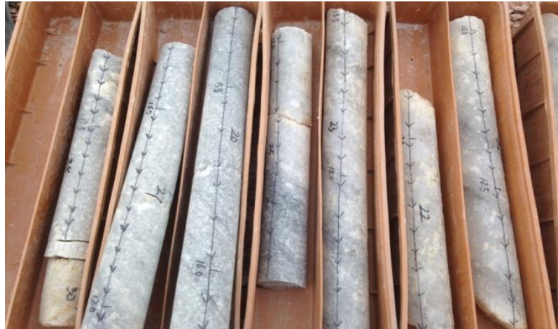
Şekil 5.2: Sondaj kuyularından alınan karot numuneleri.
